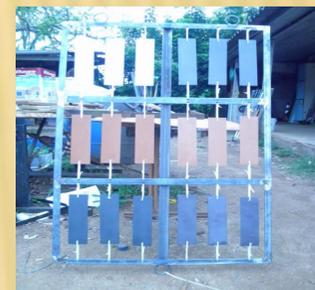
Figura 2: Corpos de prova para o teste do efeito anti-incrustante.
