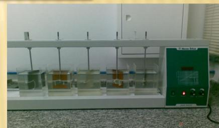
Figura 1: JAR-TEST-Equipamento utilizado para o teste de lixiviação.
