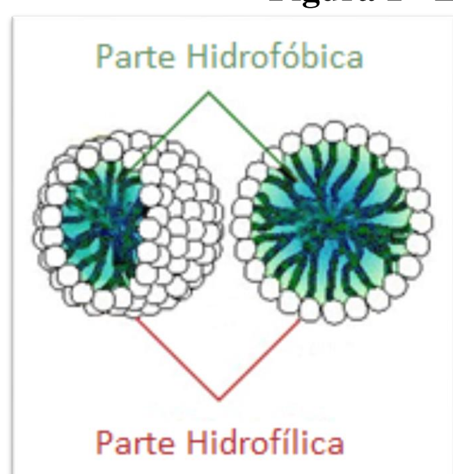
Figura 2 – Esquema de como as moléculas dos surfactantes se organizam em uma micela.
