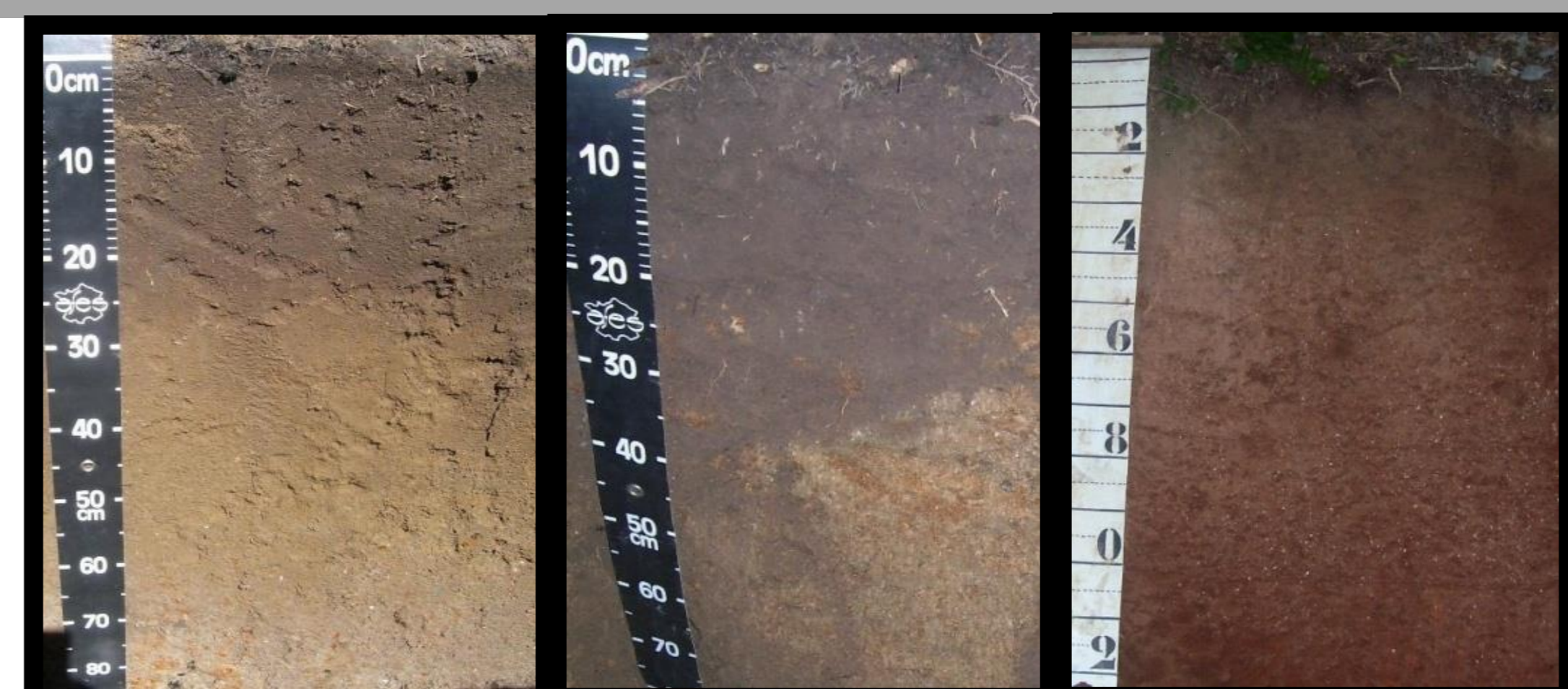
P1 - Argissolo Bruno Acinzentado Distrófico úmbrico P2 - Neossolo Regolítico Eutrófico típico P3 - Argissolo Vermelho Eutrófico abruptico
