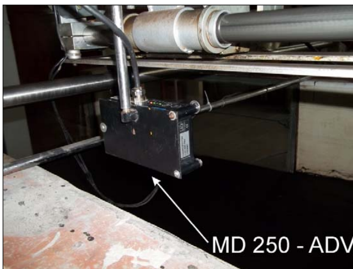
Figura 5: Laser MD250 - ADV acoplado à mesa de coordenadas.
