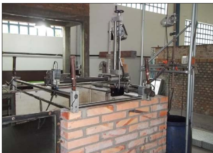
Figura 6: Mesa de coordenadas sobre o tanque de ensaios.
