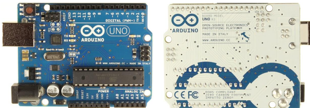
Figura 2.16 – Placa Arduino UNO Rev.3 com Atmel ATmega328 8-bit. (ARDUINO, 2013)
