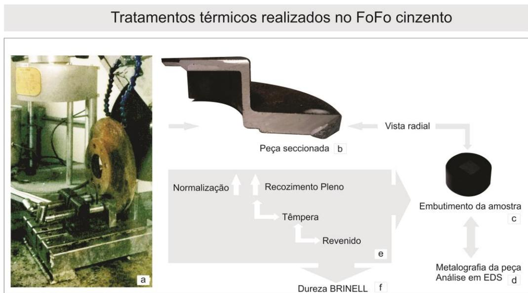
O Quadro 7 é um modelo esquemático que identifica através das letras as etapas realizadas para a elaboração dos tratamentos térmicos seguido de análises de metalografia. Primeiramente, o disco de freio foi cortado (a) na cortadeira metalográfica Pancut 100 da PANTEC com um disco abrasivo à base alumina, em função da ductilidade e da dureza do
