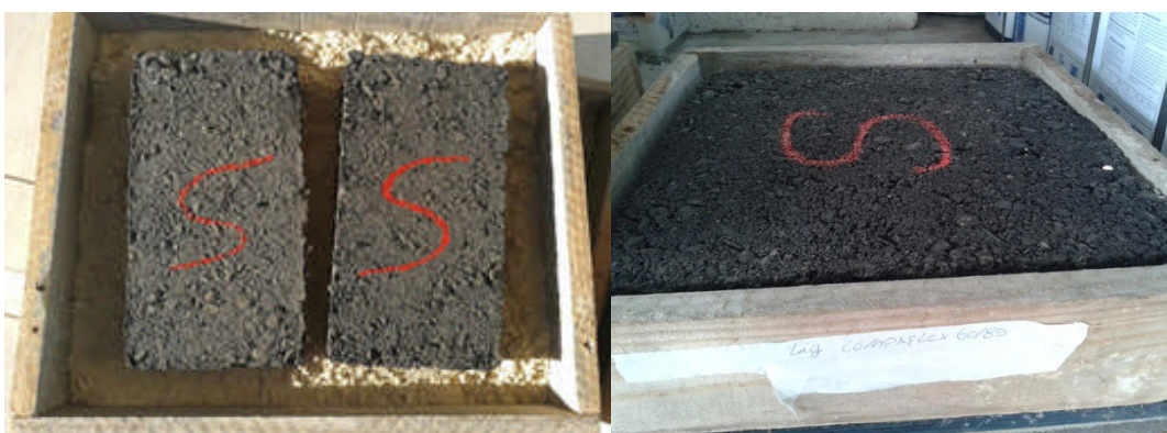
Figura 73: transporte das placas de mistura asfáltica da usina de asfalto para o local do processo de corte.
