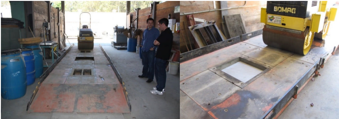
Figura 18: sistema de moldes empregados pela Universidade da Califórnia para confecção de placas em laboratório destinadas a ensaios de fadiga a flexão em quatro pontos.
