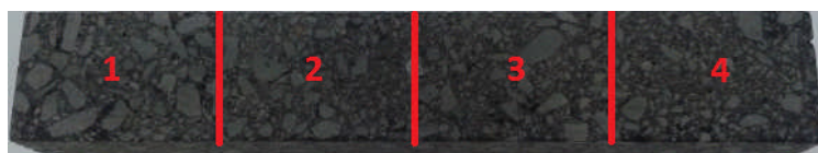
Figura 81: vigota dividida em quatro partes para ensaio de densidade aparente, grau de compactação e volume de vazios.
