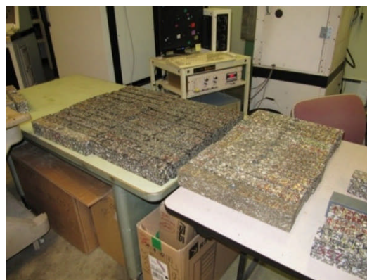
Figura 23: amostras para o ensaio de fadiga à flexão em quatro pontos, após o processo de corte, Universidade da Califórnia.
