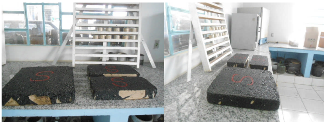
Figura 72: armazenamento das placas de mistura asfáltica.
