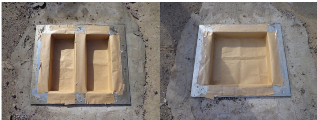
Figura 65: utilização de papel nos moldes metálicos com o intuito da massa asfáltica não aderir nas faces dos moldes.
