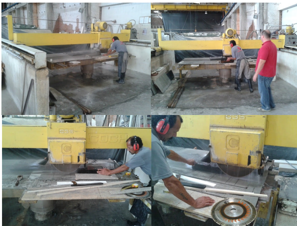
Figura 74: processo de corte das placas de mistura asfáltica para obtenção das vigotas.
