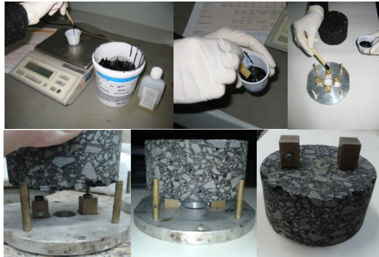
Figura 54: sequência de montagem das peças de suporte para fixação do LVDT no corpo de prova cilíndrico.
