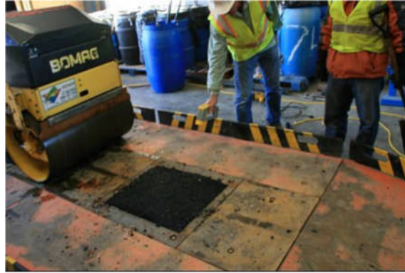
Figura 20: compactação das placas de misturas asfálticas utilizando rolo compactador, Universidade da Califórnia.
