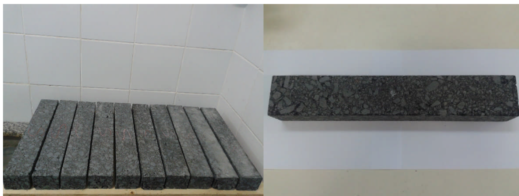
Figura 75: vigotas obtidas após o processo de corte das placas de mistura asfáltica.
