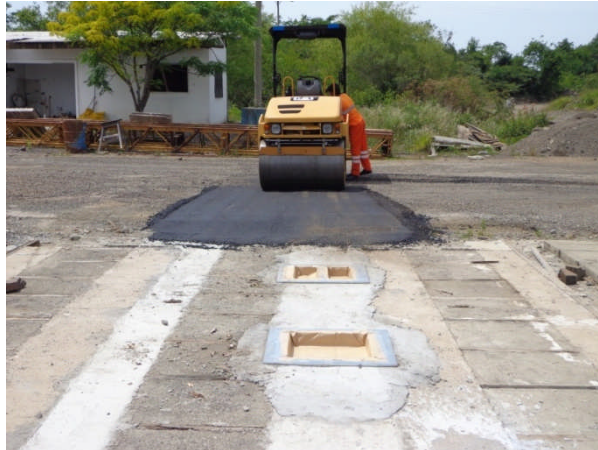
Figura 64: pista de moldagem construída na usina de asfalto para produção das placas de misturas asfálticas.
