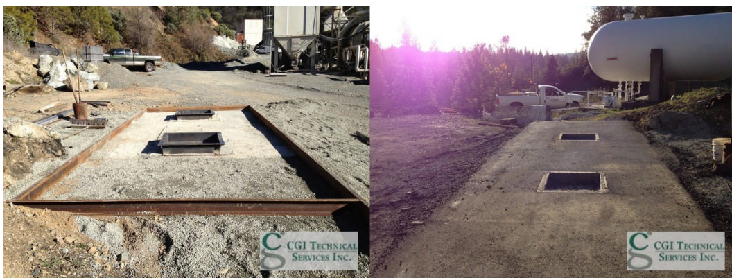
Figura 21: sistema de moldes empregados pela Universidade da Califórnia para confecção de placas em campo destinadas a ensaios de fadiga a quatro pontos.
