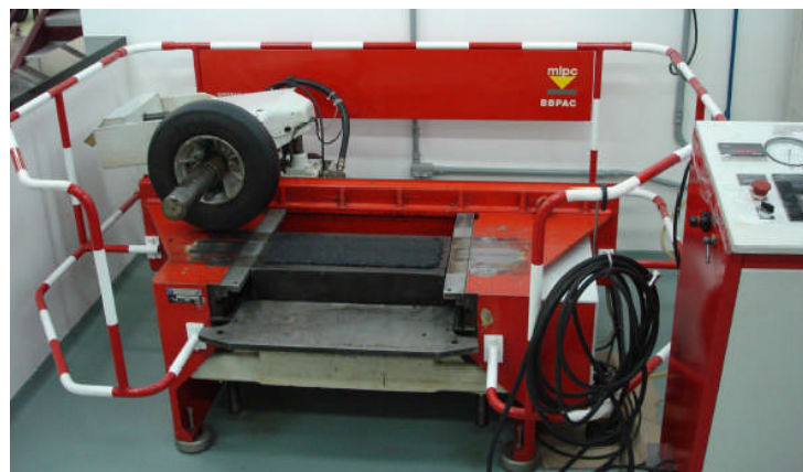
Figura 26: mesa compactadora francesa tipo LCPC (Moura, 2010).
