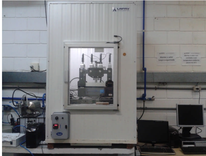
Figura 34: câmara climática utilizada para realização dos ensaios de flexão em viga quatro pontos e módulo complexo.
