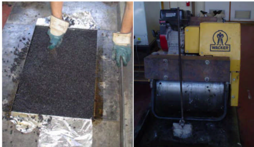
Figura 24: sistema de moldagem e compactação de vigas utilizado por Fontes (2009).
