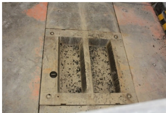
Figura 19: detalhe do molde empregado pela Universidade da Califórnia para confecção de placa para serrar quatro vigas, sendo obtidas duas vigas por vão.
