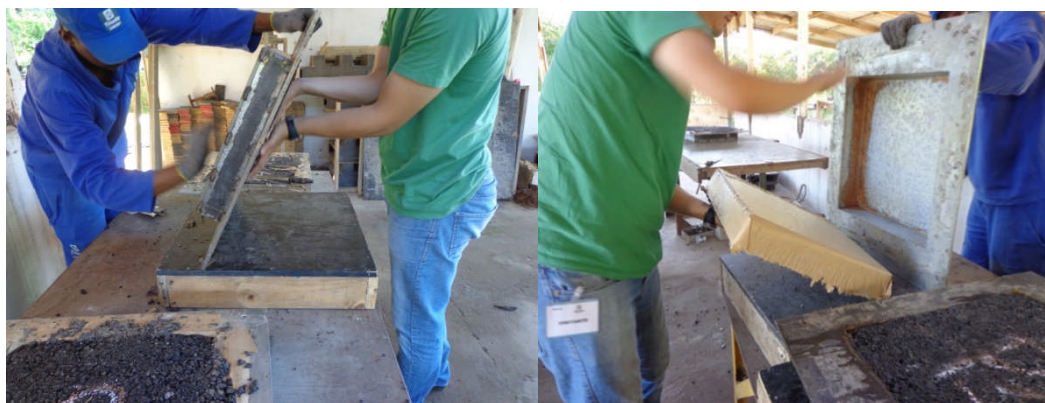
Figura 71: processo de desmoldagem das placas de mistura asfáltica.
