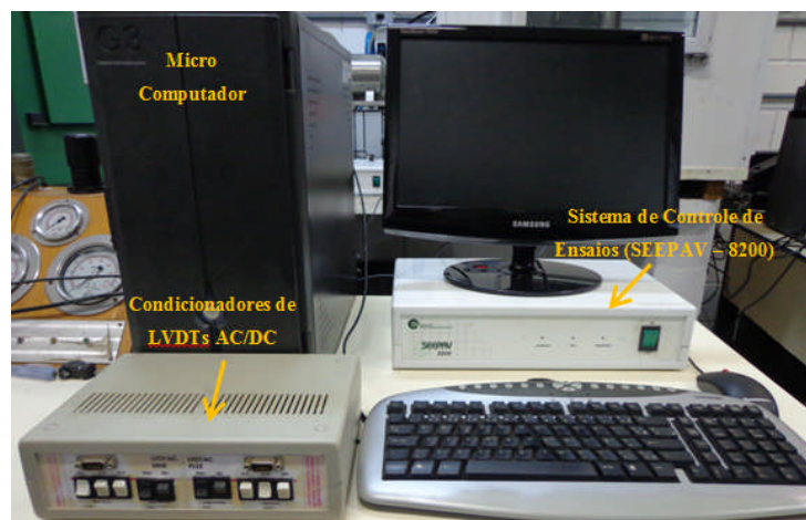
Figura 50: sistema de aquisição e controle de dados do equipamento de ensaio de fadiga por compressão diametral.
