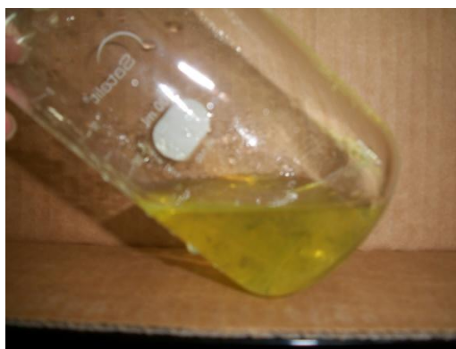
Figura 27- Gel formado após adição de HCl a 25% ao produto obtido por fusão das cinzas com NaOH na temperatura de 800°C e tempo de 5 horas (1C5).
