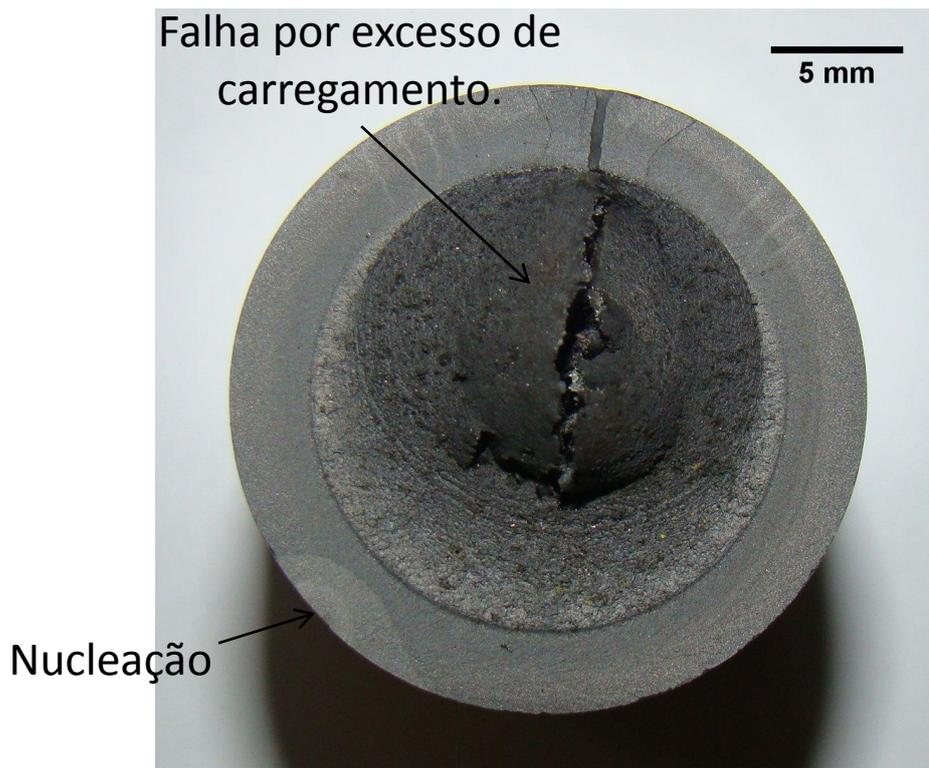
Figura 4.16 - Fratura Amostra 2.
