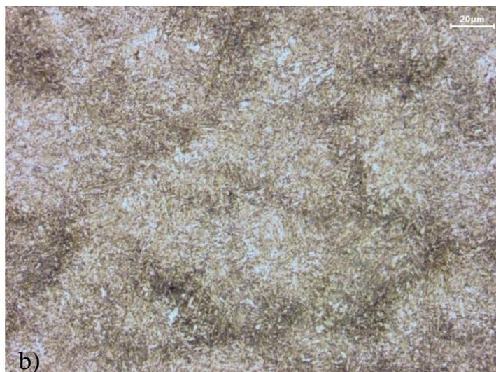
Figura 4.1 - Microestrutura Grupo A. a) superfície e b) núcleo respectivamente. MO, 500x, Ataque Nital 2%.
