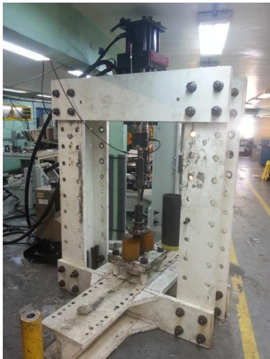
Figura 3.9 - Equipamento ensaio de Fadiga.
