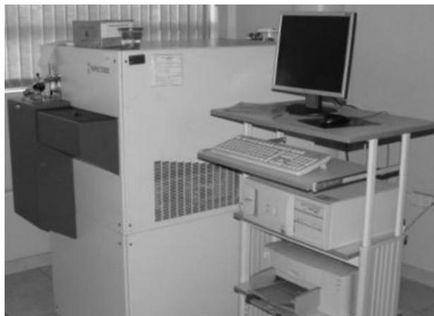
Figura 3.1 - Espectrômetro de centelha Spectro.
