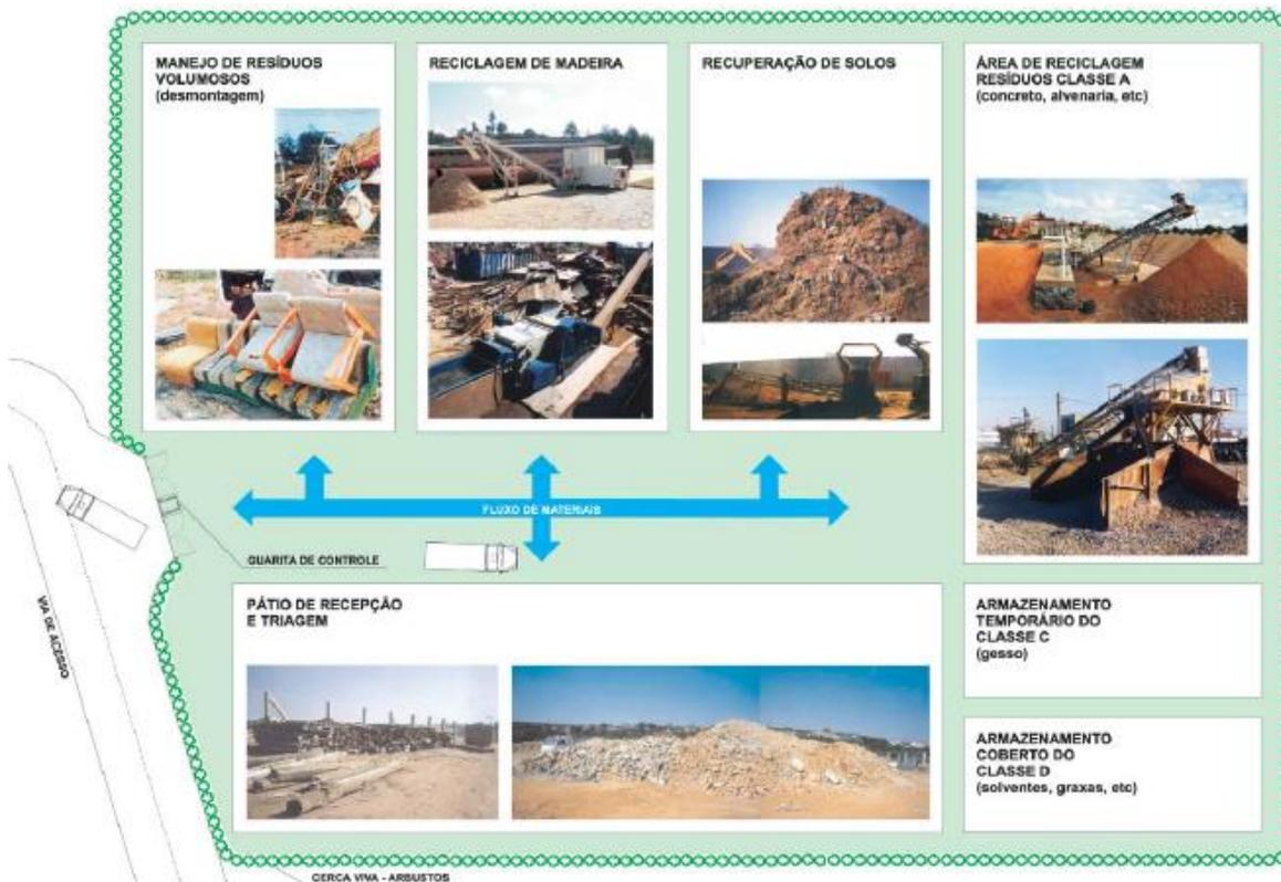
**Figura 9** - *Layout* sugerido para organização de área de triagem e reciclagem de RCD.
