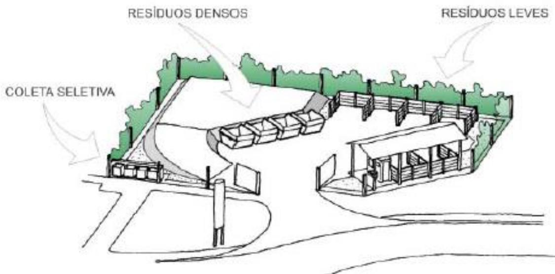
**Figura 8** - Esquema sugerido para construção de ‘ecopontos’.
