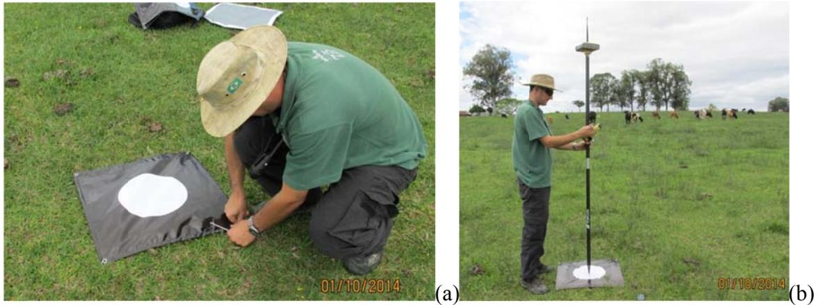
Figura 17: Alvos. a) Fixação no solo; b) Rastreio pelo método RTK, usando receptor geodésico.
