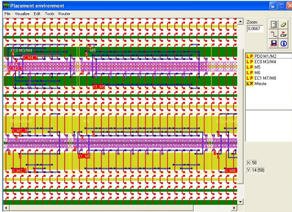
Figura B.14: Tela ambiente de posicionamento de células da ferramenta LIT.
