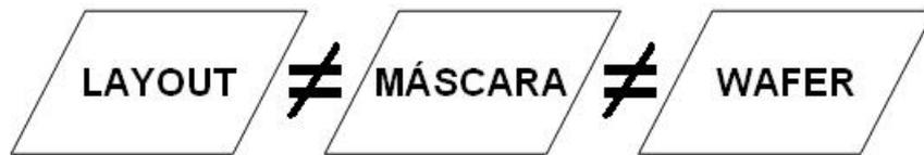
Figura 4.1: Ruptura do regime “WYSIWYG”: os polígonos desenhados no *layout* não refletem as geometrias reais da máscara, as quais, por sua vez, também não refletem as geometrias reais fabricadas em silício.
