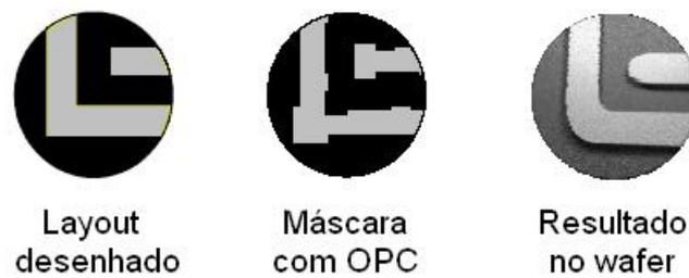
Figura 4.3: Exemplo de *layout* no qual foi aplicado OPC, mostrando a inserção de *serifs* e *hammerheads* na máscara e o resultado final impresso no *wafer*.
