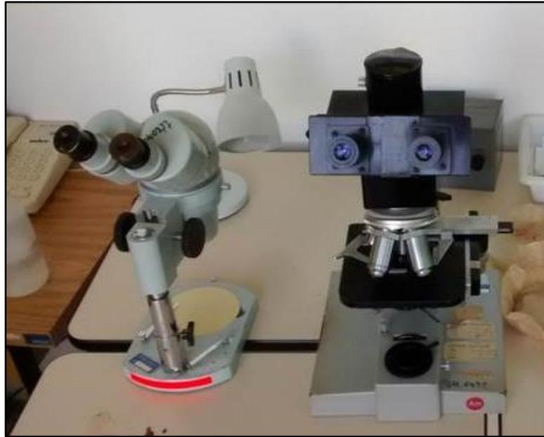
Figura 22 Equipamentos utilizados para separação do material e análise: lupa estereoscópica (à esquerda) e microscópio óptico binocular (à direita).
