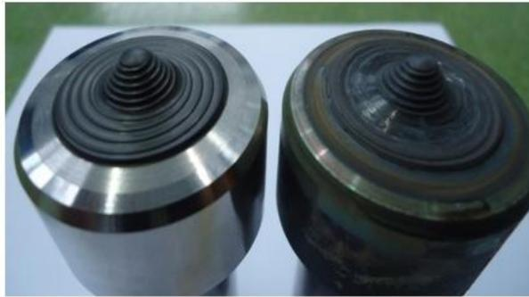
(a) Ferramenta nova e ferramenta após 4,9 metros de solda
