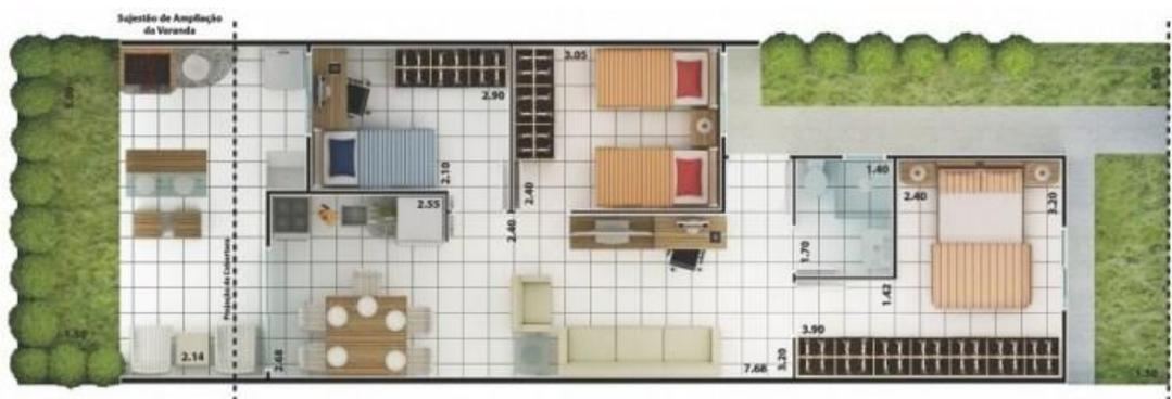
Figura 13: Planta baixa das casas três dormitórios do empreendimento A2 (Fonte: Empresa A)
