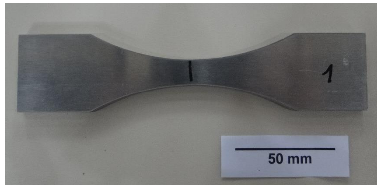
Figura 4.9 – Exemplo de peça utilizada no estudo dimensional, com destaque para a região medida.
