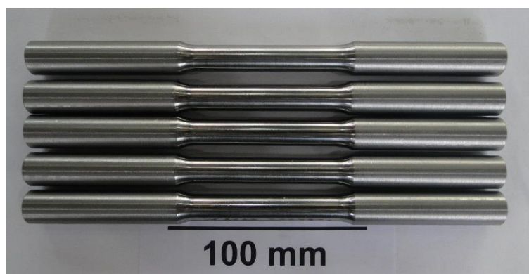
Figura 4.2 – Corpos de prova para ensaios de tração no interlaboratorial de 2014.
