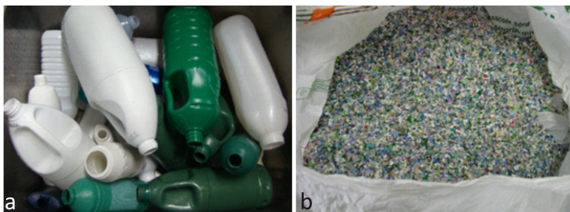
Figura 36 - Embalagens de PEAD de produtos de limpeza pós consumo após a limpeza (a) e na forma de flakes após a moagem (b).
