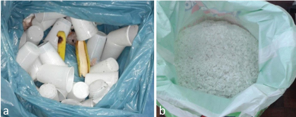
Figura 37 - a) Resíduo de PSAI recolhido no RU da UFRGS; b) Resultado após lavagem e moagem.
