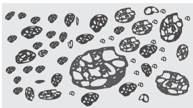
Figura 28. Ilustração da morfologia do PSAI (Fase contínua: PS, fase dispersa: PB). Sarkis, 2009
