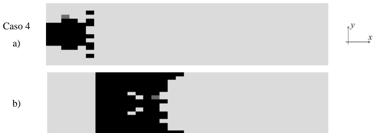
Figura 6.9 – Topologia ótima para o Caso 4 (um modo de vibração). a) Lâmina ativa da estrutura, b) Lâmina inferior da estrutura.
