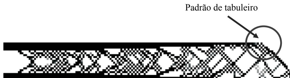
Figura 4.8 – Representação de um resultado com padrão de instabilidade de tabuleiro de xadrez [Bendsøe e Sigmund, 2003].
