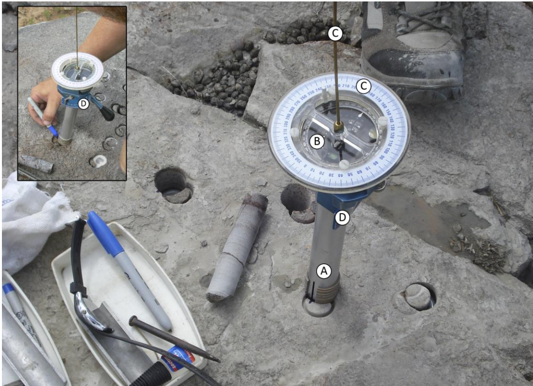
Figura 4.4: Orientador dos testemunhos cilíndricos: a) Haste cilíndrica de alumínio com ranhura na base; b) bússola magnética (modelo Brunton ) acoplada a haste cilíndrica; c) Transferidor de 360° e haste de metal, para fazer a leitura do azimute solar; d) Transferidor de 90° para medir a inclinação do furo. (Extraído de Sbaraini (2012)).
