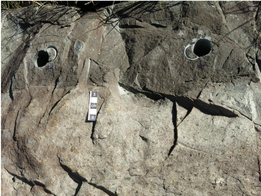
Figura 4.3: a) Marcação feita inicialmente, quando o furo atinge 1 cm; b) Perfuração concluída, espaço onde foi retirado o testemunho cilíndrico.
