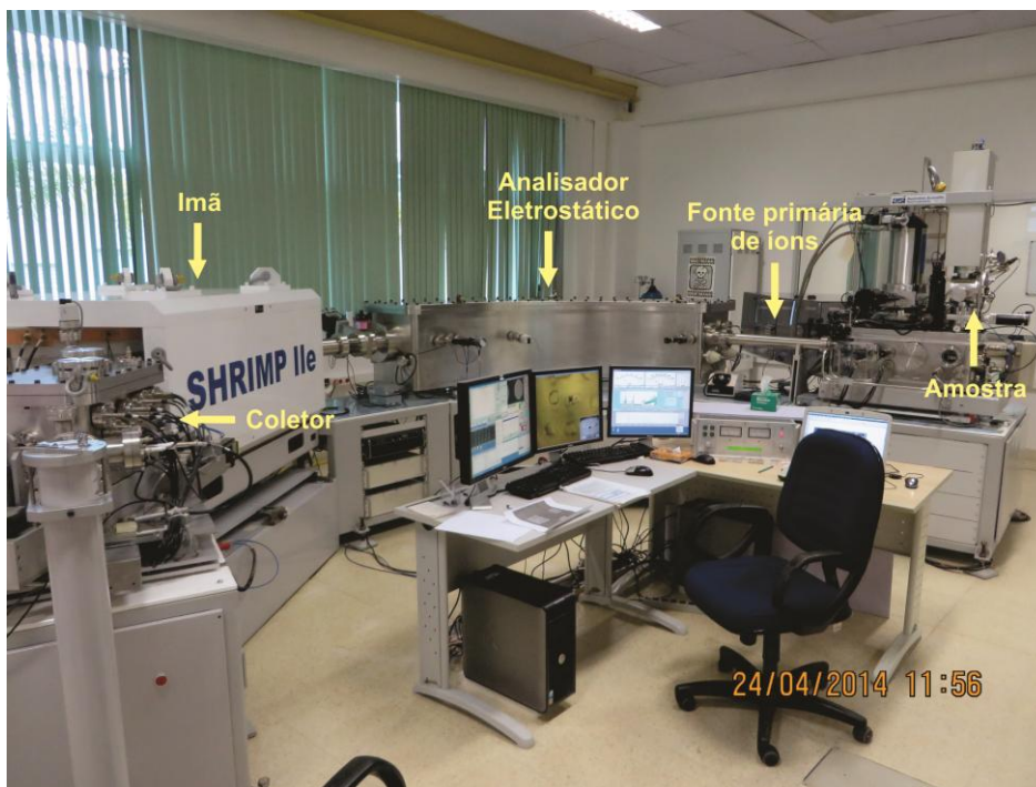
Figura 2 - Fotografia do equipamento USP SHRIMP-IIe durante a sessão realizada pelo autor, com a indicação de alguns componentes do equipamento.
