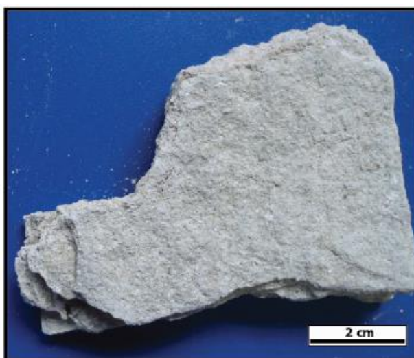
Figura 36. Packstone com laminação paralela rico em ostracodes.
