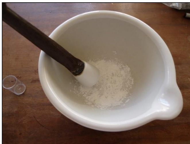
Figura 19. Amostra CH-39-F pulverizada para análise de Difração de Raio-X.
