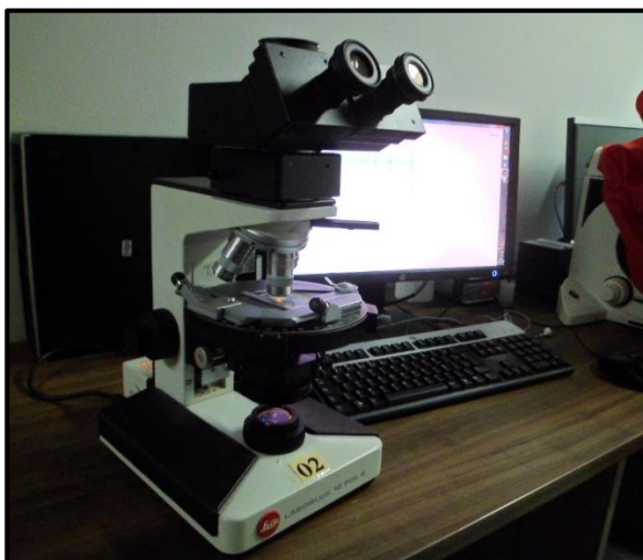
Figura 18. Microscópio Leitz Laborlux 12 com charriot acoplado.
