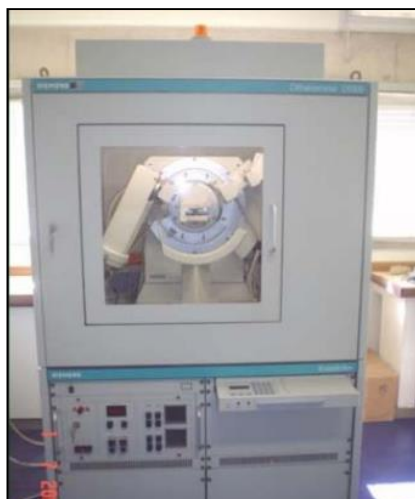
Figura 20. Foto do difratômetro SIEMENS 5000.
