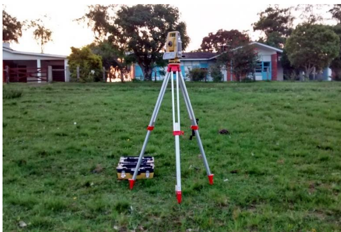
Figura 3.20: Levantamento com a estação total
