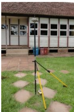
Figura 4.4: Medição de um ponto para o controle de qualidade horizontal
