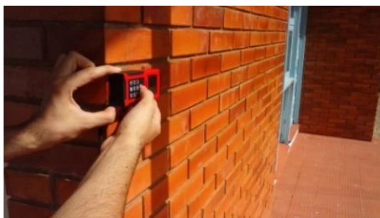
Figura 3.22: Levantamento com a trena eletrônica
