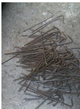
Figura 3.9: Spikes fabricados para a fixação dos alvos em campo.
