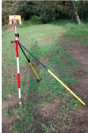
Figura 3.21: Medição de um ponto de ré
