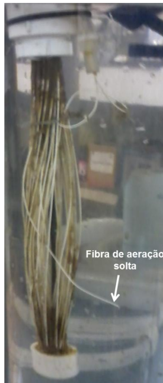
Figura 4.18: Fotografia da fibra de aeração solta ao longo do processo, na vazão de 5 \text{ L}\cdot\text{min}^{-1} , Modo 2 de aeração.
