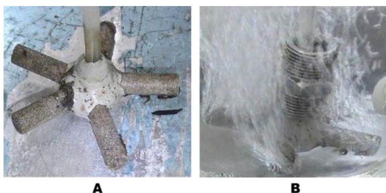
Figura 3.7: A – Fotografia do aerador utilizado no fundo do tanque; B – Detalhe da formação de bolhas.
