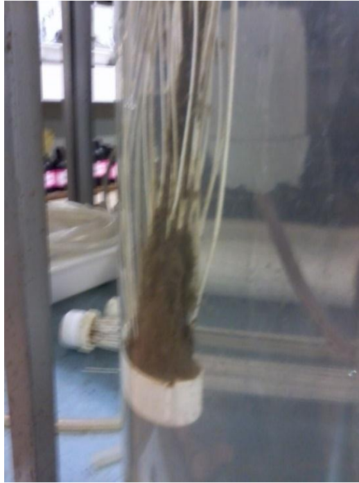
Figura 4.9: Fotografia do acúmulo de lodo na superfície da membrana, na parte inferior do módulo, na condição de 2 \text{ L}\cdot\text{min}^{-1} , pressão transmembrana de 600 mbar, temperatura de 27^\circ\text{C} , diâmetro do módulo de \frac{3}{4} \text{ in} , concentração SSV do lodo de 8.000 \text{ mg}\cdot\text{L}^{-1} .
