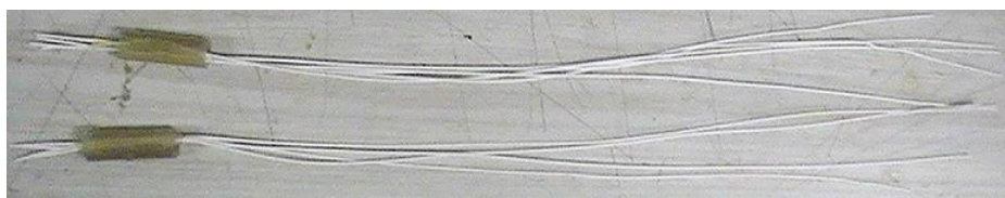
Figura 3.8: Fotografia dos aeradores utilizados no interior do módulo de membranas.
