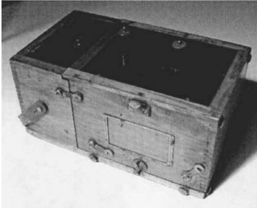
Figura 1: Analisador de QEE desenvolvido pela General Eletric em 1920. (DUGAN, 1996)
