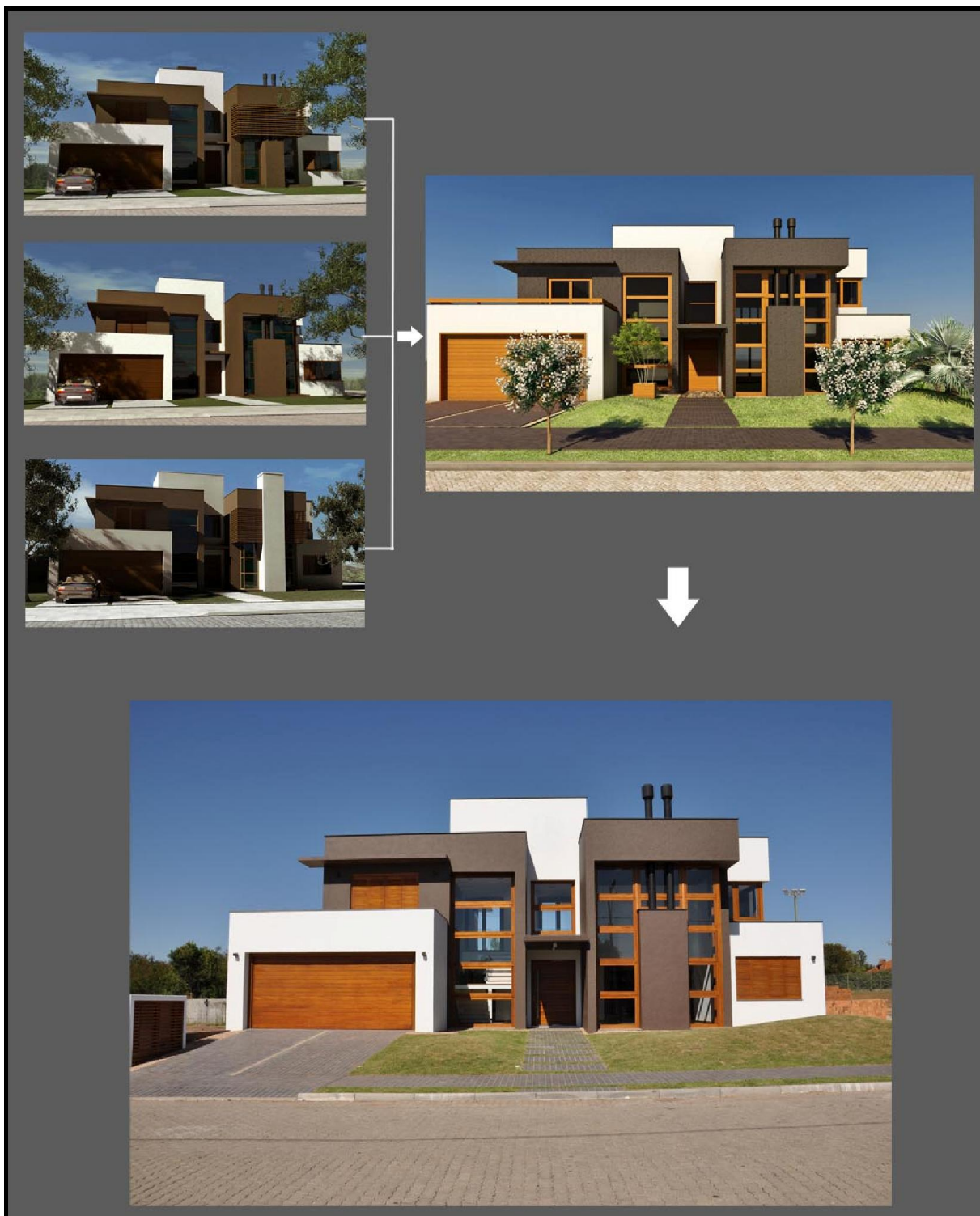
Figura 28 - O computador como ferramenta de concepção e verificação. Série de testes volumétricos tridimensionais, de onde saiu a solução formal final aprovada pelo cliente e posteriormente construída. Projeto: Lineastudio Arquiteturas - Fonte das imagens e foto: autor.
