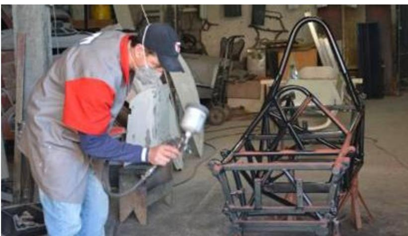
Figura 110: Após a troca dos tubos oxidados, pintura protetora multicamadas no chassis. Foto do autor.
