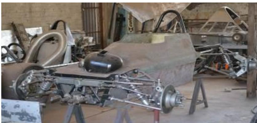
Figura 111: Pré-ajuste da carenagem de fibra junto com os demais componentes, antes da pintura final. Foto do autor.
