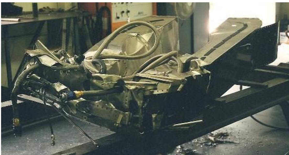
Figura 107: Shadow DN 5 de fórmula 1, após uma saída de pista em uma prova de carros históricos de grande prêmio
