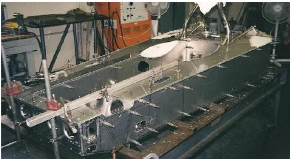
Figura 108: As chapas do chassis que não puderam ser recuperadas ou calandradas, foram substituídas.
