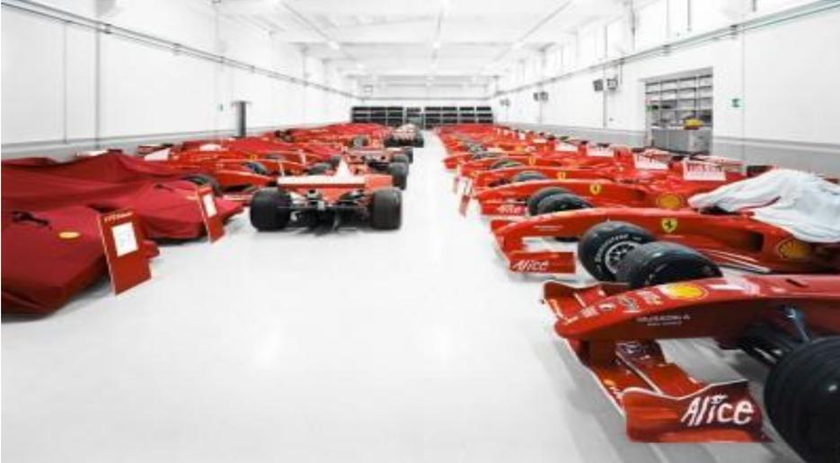
Figuras 47: Reserva Técnica da Ferrari. A maioria dos carros cobertos para evitar a luz e o pó e com nitrogênio inflando os pneumáticos como elemento redutor da degradação do elastômero.
