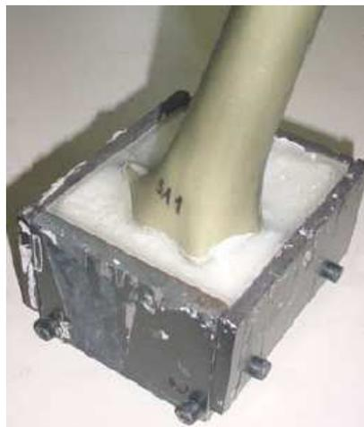
Figura 3.4 – Dispositivo utilizado para fixação dos fêmures.
