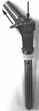
Figura 2.19 – Uma haste femoral Bridge revisada que teve a camada de cimento proximal removida. As setas indicam os locais de entrada e saída do cimento. As vedações de polietileno primária e secundária, localizadas no terço proximal da prótese, evitam a extrusão de cimento distal (VORA 2003).
