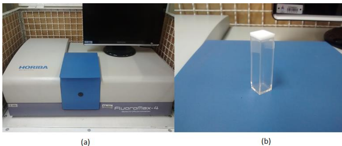
Figura 4-3: (a) Espectrofluorômetro Fluoromax-4 e (b) cubeta de quartzo com caminho óptico de 1cm.
