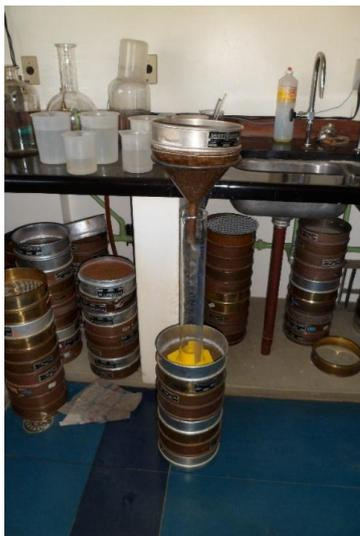
Figura 34. Material passado em peneira com malha de 0.062 mm.
