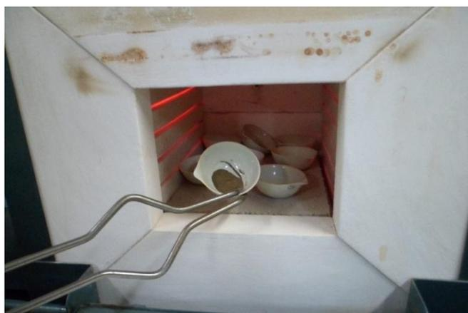
Figura 59. Material levado ao forno para detecção de matéria orgânica.
