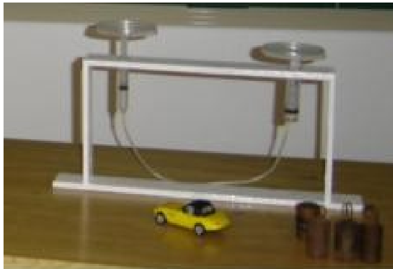
Figura 2: A nossa montagem do Elevador Hidráulico
