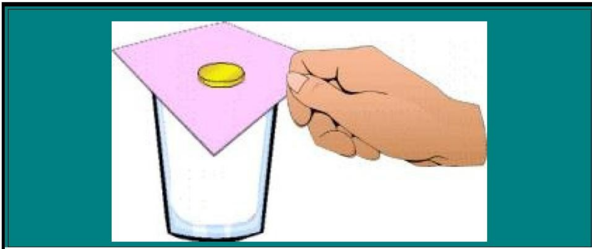
Figura 2.3.: Ao puxar bruscamente, a cartolina acelera e a moeda cai dentro do copo.
