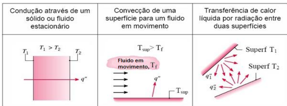
Figura 6. Mecanismos de transferência de calor (Incropera et al. , 1998). " T é a temperatura dos meios e q o fluxo de calor.
