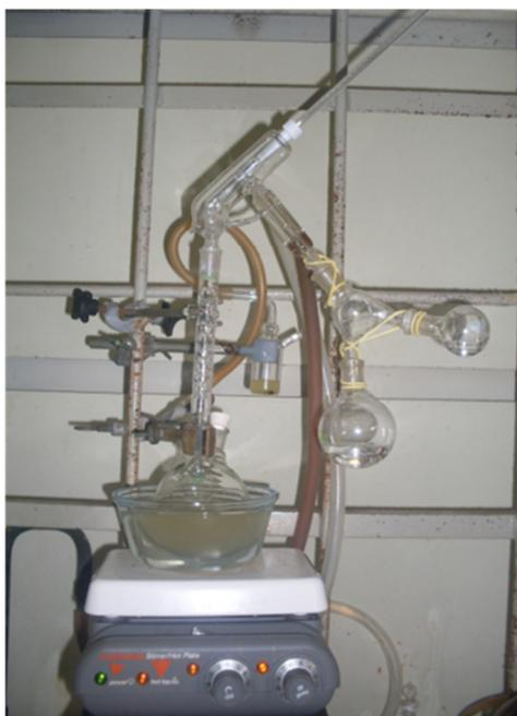
Figura 15: Sistema de destilação fracionada utilizado para a purificação do etanol.
