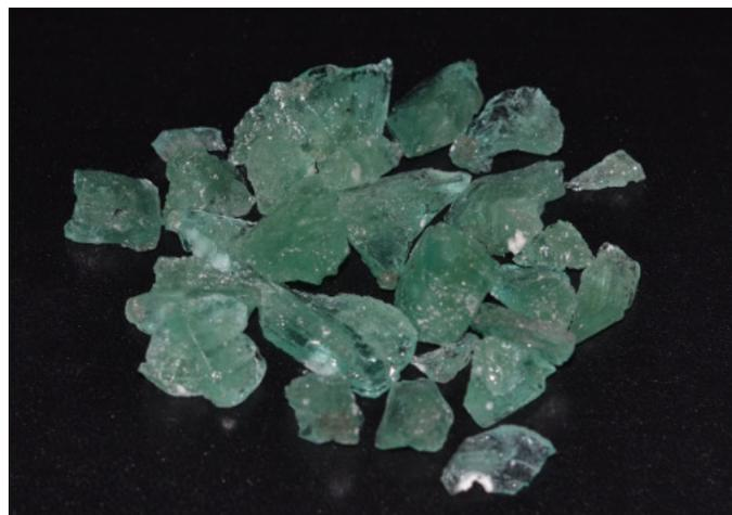
**Figuras 37. Sulfato ferroso heptahidratado recristalizado – LOTE 2.**
