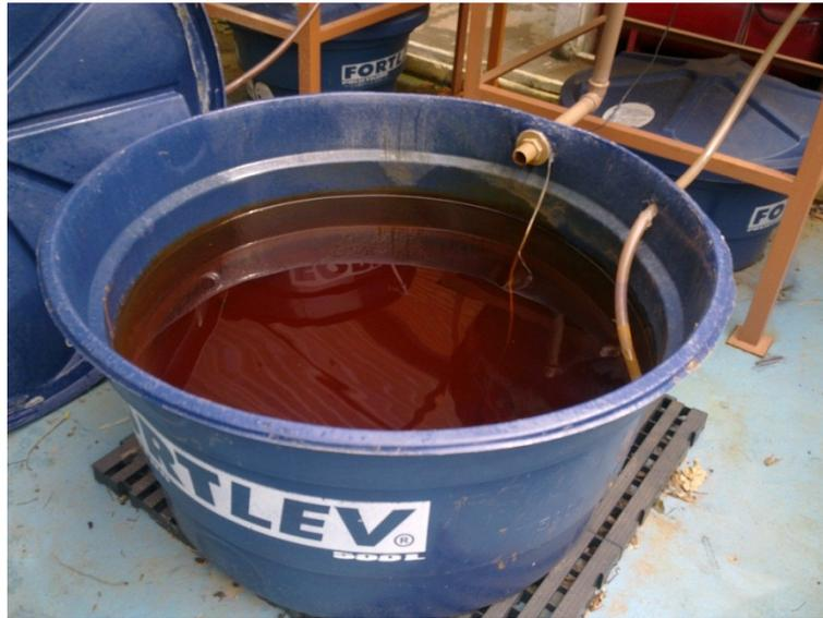
**Figura 20. Lixiviado férrico/ferroso gerado durante o processo de lixiviação – LOTE 1.**
