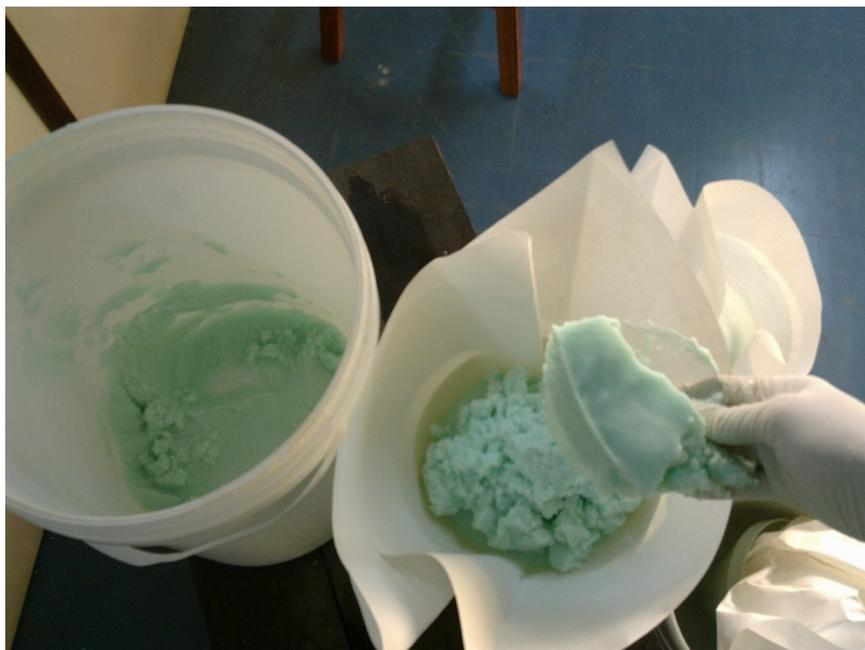
**Figura 35: Sulfato ferroso após filtração em temperatura ambiente.**
