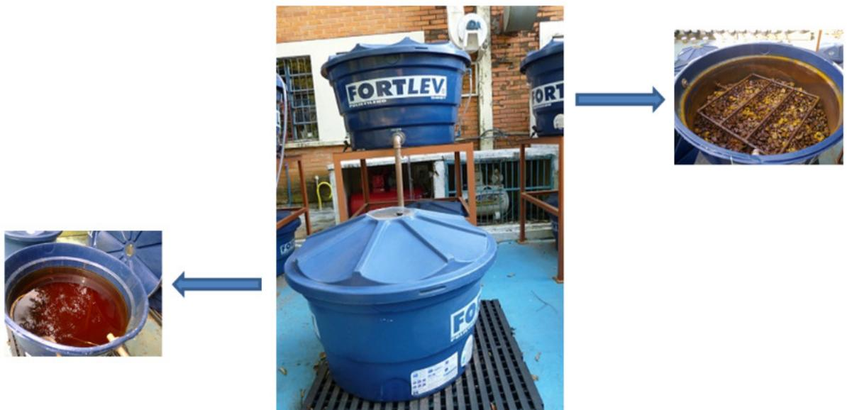
**Figura 12: Imagem da planta piloto montada no Centro de Tecnologia da UFRGS para lixiviação/redução do concentrado piritoso e produção de sulfato ferroso.**
