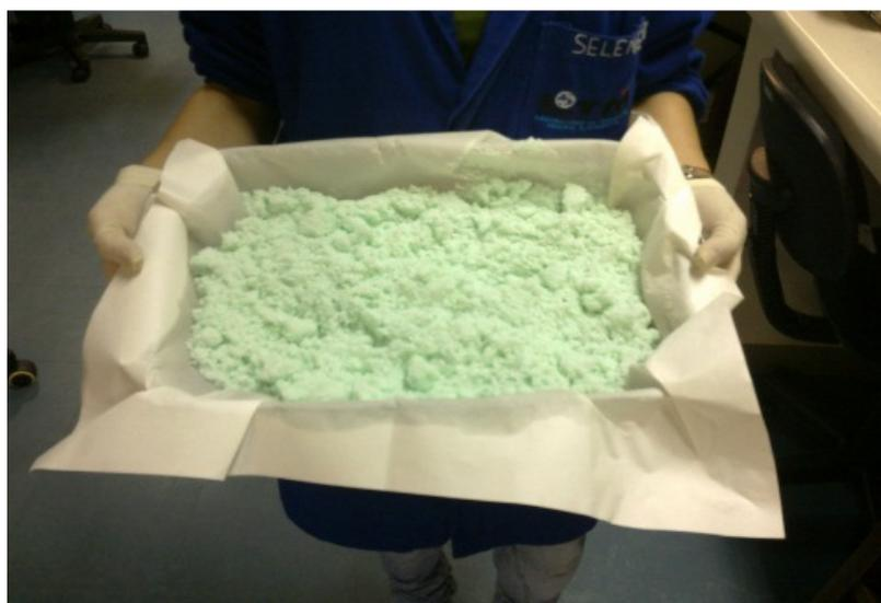
**Figura 25: Sulfato ferroso após secagem em temperatura ambiente – LOTE 1.**
