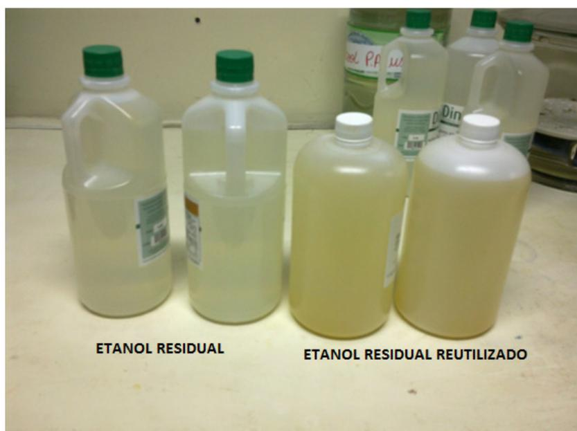
**Figura 27: Aspecto do etanol residual e do etanol residual reutilizado após as etapas de precipitação do sulfato ferroso produzido no LOTE 1.**
