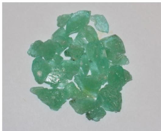
**Figura 28. Sulfato ferroso heptahidratado recristalizado – LOTE 1.**
