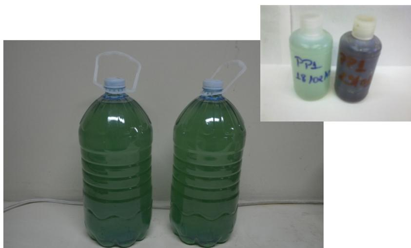
Figura 23. Lixiviado ferroso após o processo de redução – LOTE 1 (abaixo) e comparação do aspecto dos lixiviados ao final da etapa de redução com a etapa de oxidação (acima).
