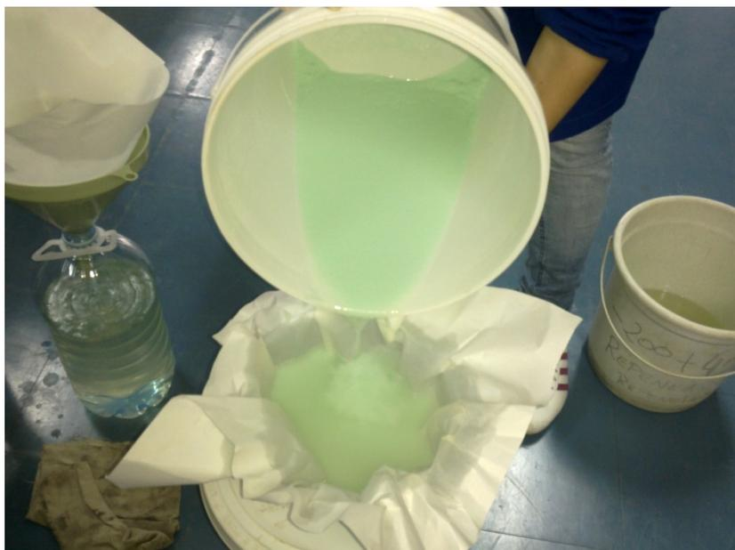
**Figura 24: Processo de filtração do sulfato ferroso precipitado em etanol.**
