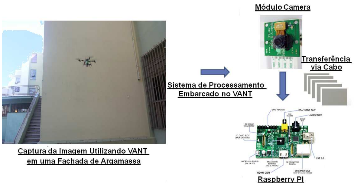
Figura 78 - Cenário B: O VANT captura as imagens e realiza o processamento em uma plataforma embarcada, ainda durante o voo.
