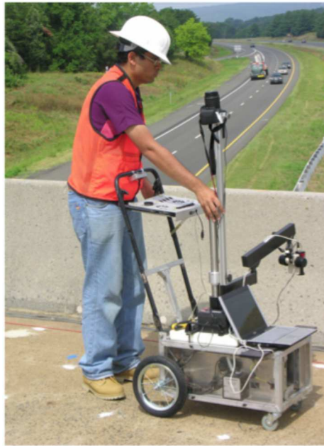
Figura 39 Protótipo do sistema de detecção de fissuras em concreto.
