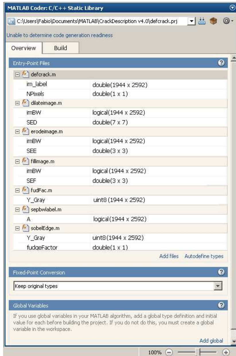
Figura 58 Definições dos tipos e tamanho dos dados de entrada do Algoritmo A
