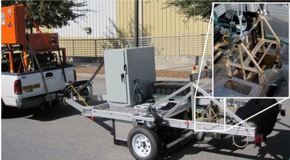
Figura 38 Protótipo do sistema de vedação de rachaduras de pavimento.
