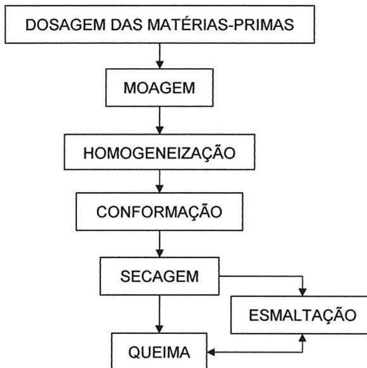
FIGURA 2.1 - Fluxograma das principais etapas do processamento de uma placa cerâmica para revestimento.
