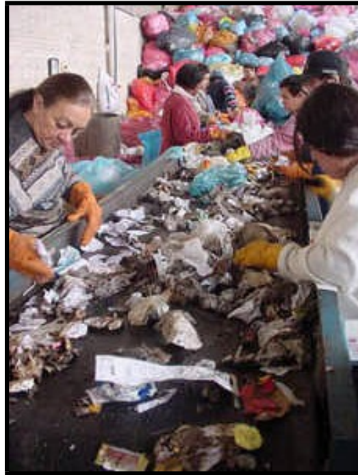
Figura 21 - Esteira de separação de materiais do Pavilhão de Triagem de Mathias Velho. Data de 06/06/2003
