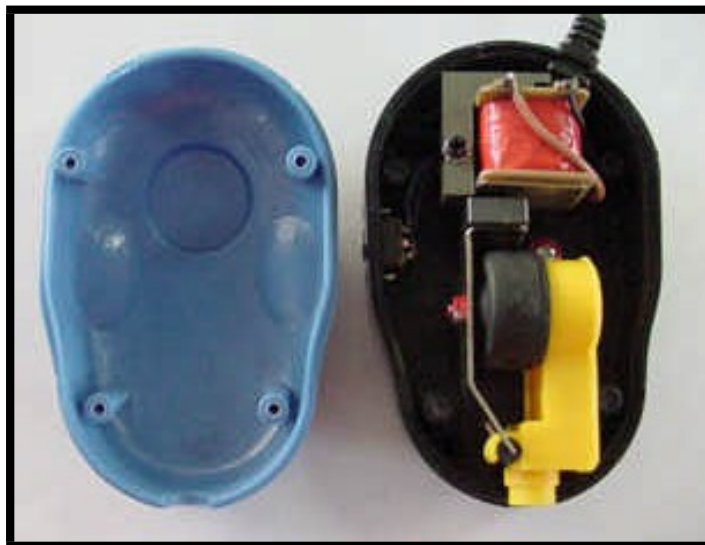
Figura 45 - Vista interna da bomba de ar modelo Trackball.
