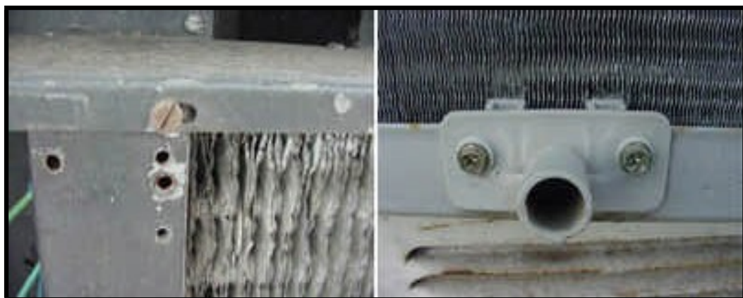
Figura 34 - Carenagem de aço e trocador de calor em alumínio de ar condicionado observada no ferro-velho Pampell. Data de 28/07/2003.
