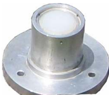
Figura 41: foto do Solarímetro utilizado
