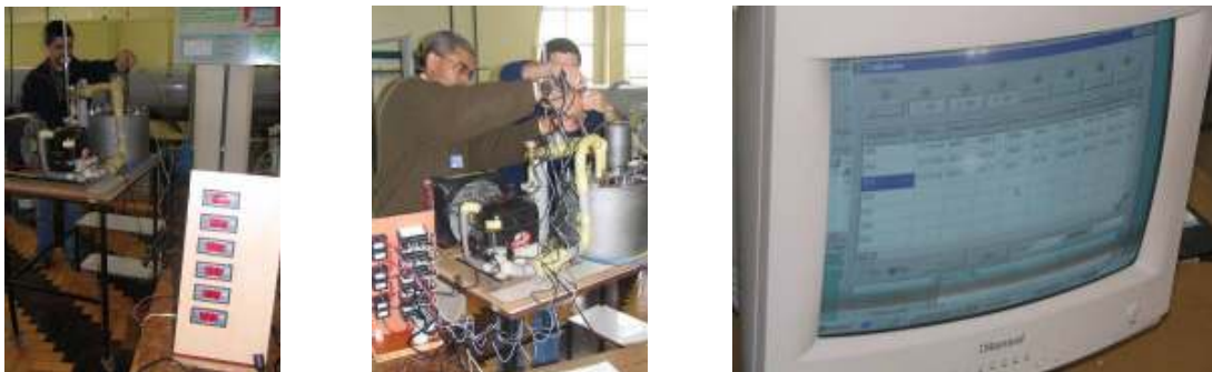
Figura 33: fotos da calibração dos sensores NTC de medição de temperatura
