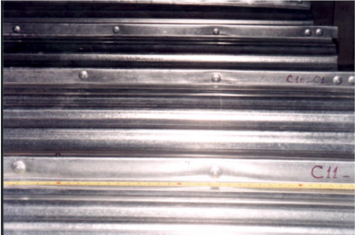
Figura 4.16 - Mostra, na condição de ligação denominada 4, na telha central do espécime 1, as capas 10 e 11 (ensaio 16 - E1-4). Observa-se também a linha de parafusos com espaçamento de 50 cm .
