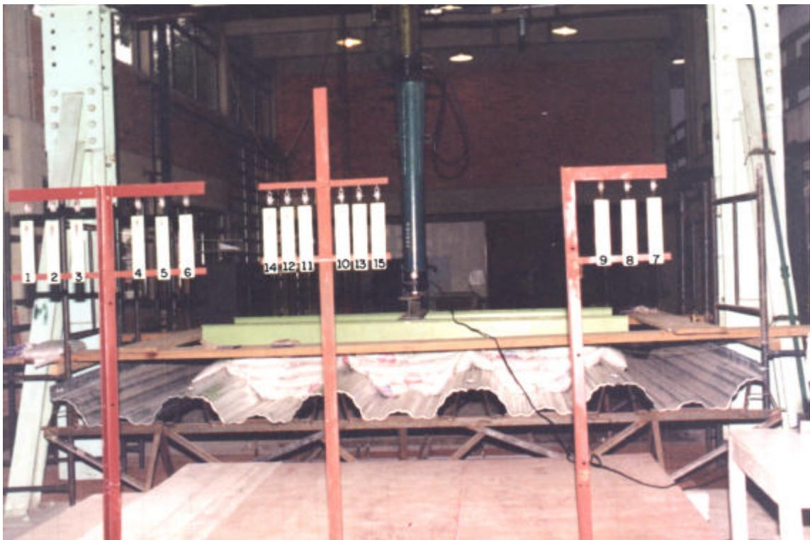
Figura 3.18 - Observa-se, a partir do apoio norte, a forma de carregamento transversal das três telhas internas, duas linhas de cargas paralelas, aplicadas sobre os terços do comprimento do vão dos espécimes ensaiados.
