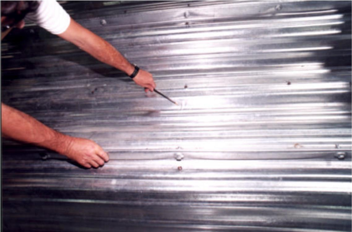
Figura 4.14 - Detalhe, na metade da telha central, próximo do ponto P5, de um leve dobramento localizado, decorrente do processo de perfilação, observado antes da utilização da telha nos ensaios. Esse tipo de dobramento foi observado em outros locais da telha central e também nas demais telhas (direita e esquerda) do espécime 1.
