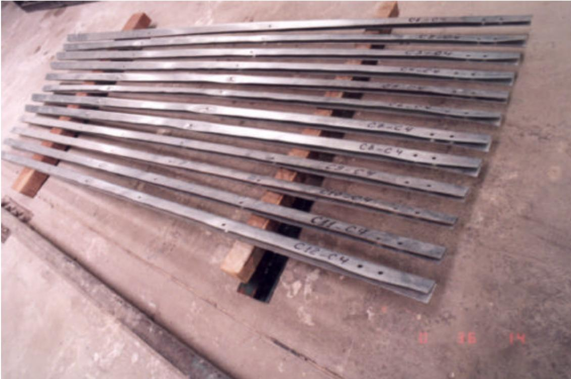
Figura 3.5 - Mostra as 12 capas utilizadas no espécime 4, para as condições de ligação das telhas, designadas como 2, 3 e 4.
