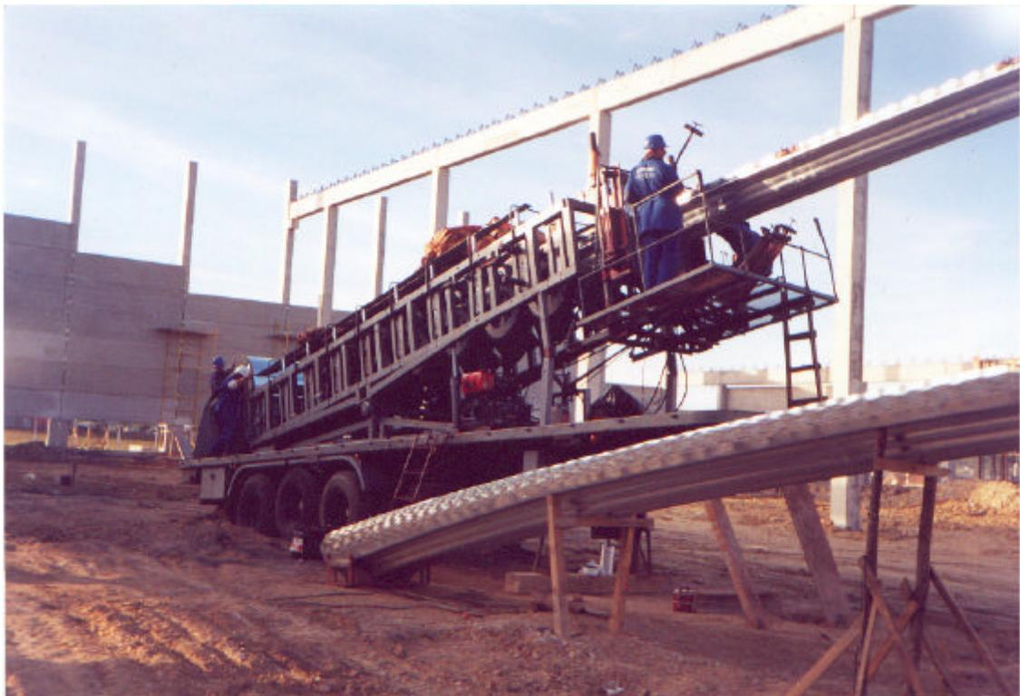
Figura 1.3 - Mostra, parcialmente, a perfiladora sobre eixos rodoviários e o processo de produção de telhas autoportantes em aço zincado. A telha, observada nesta imagem, tem a mesma seção transversal das que foram utilizadas na formação dos espécimes ensaiados.
