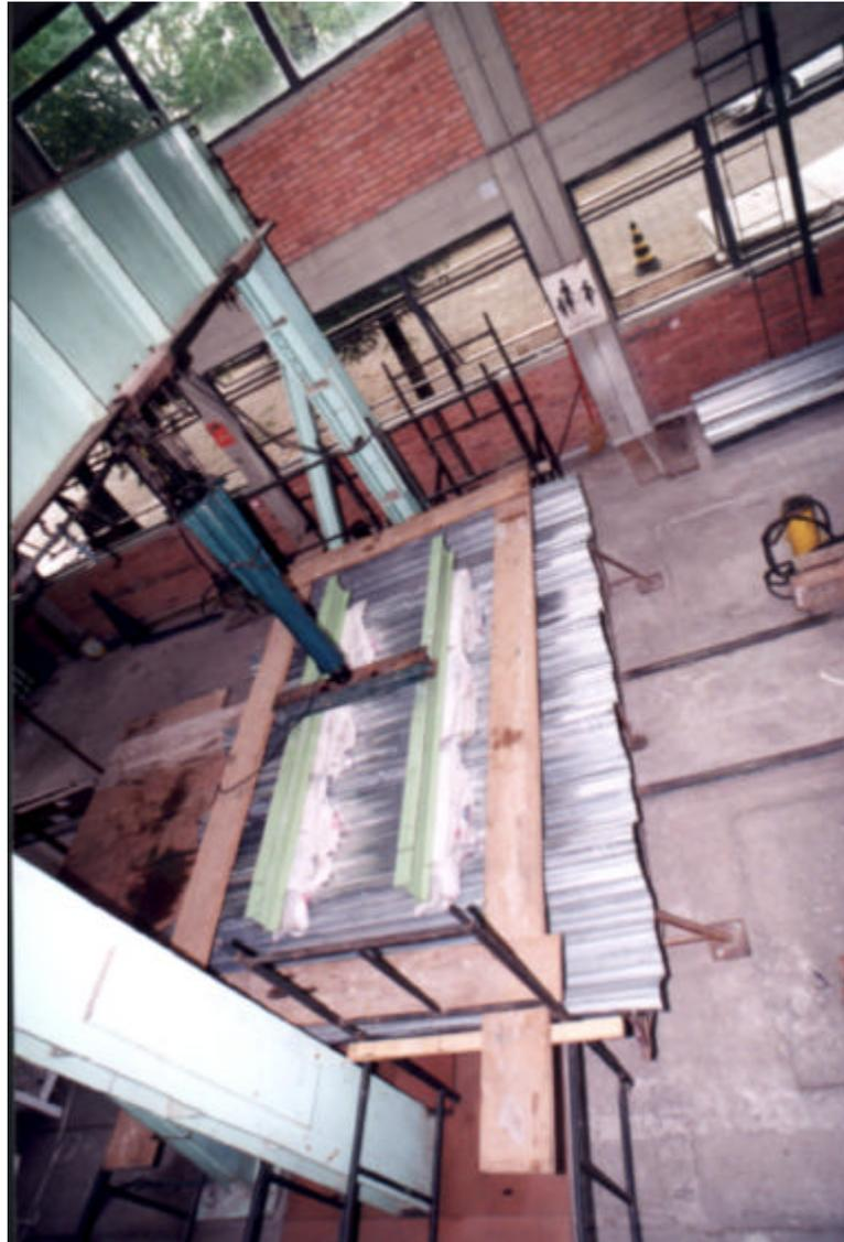
Figura 4.18 - Mostra o ensaio E1-4 (ensaio 16) das três telhas internas do espécime, na primeira etapa do carregamento, correspondente a carga de 3,72 kN. Observa-se, de baixo para cima, na seguinte ordem, telha 1, telha direita, telha central, telha esquerda e telha 5. As telhas de extremidade (1 e 5) foram utilizadas em todos os ensaios de cada espécime.
