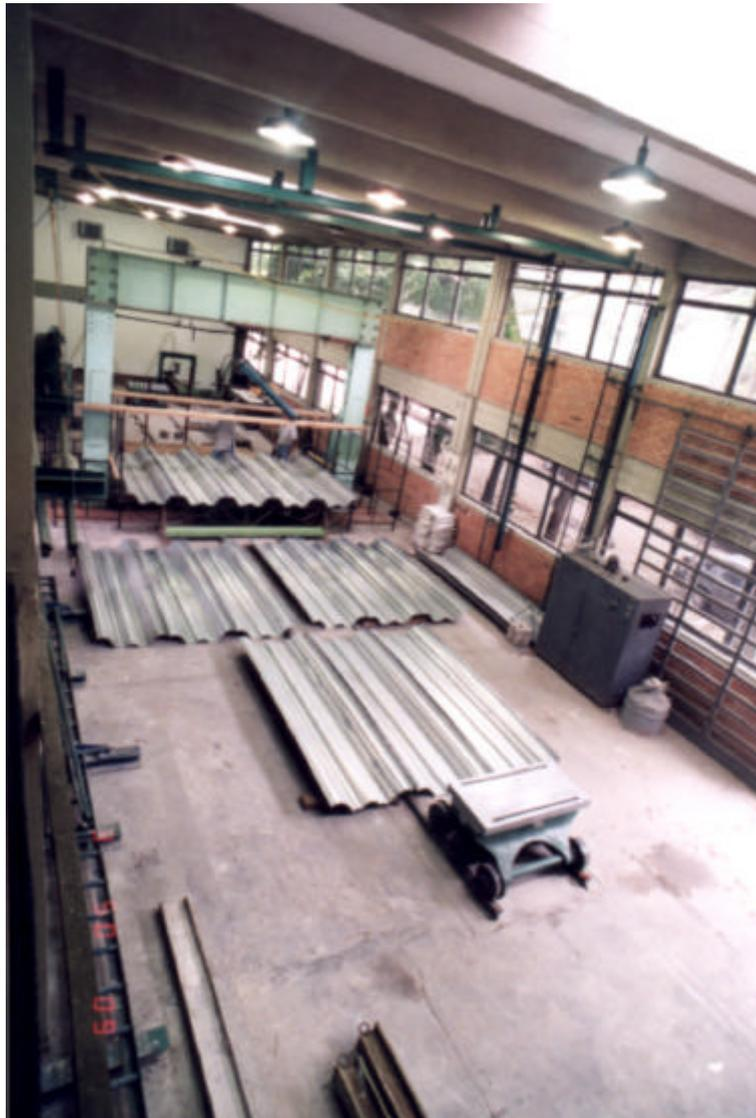
Figura 3.1 - Mostra a formação dos quatro espécimes de telhas metálicas autoportantes. Observa-se, no primeiro plano da figura, as três telhas internas do espécime 3, no plano central, a esquerda, as telhas do espécime 2 e, a direita, as telhas do espécime 4; no último plano, sob o pórtico, o espécime 1 constituído de três telhas internas e das duas telhas de extremidade utilizadas na formação de todos os espécimes .
