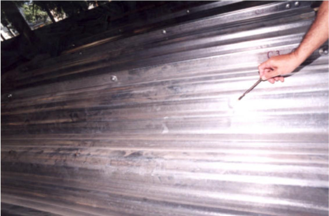
Figura 4.46 - Detalhe, na telha direita, próximo do apoio sul do espécime, de um leve dobramento localizado, decorrente do processo de perfilação, observado antes da utilização da telha nos ensaios. Esse tipo de dobramento foi observado em outros locais da telha direita e também nas demais telhas (central e esquerda) do espécime 3.
