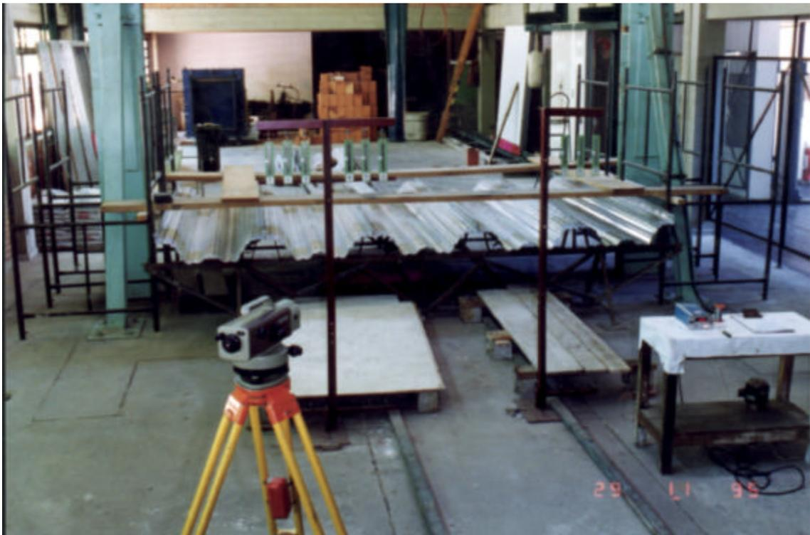
Figura 3.19 - Mostra o Nível de Precisão Wild N3 utilizado no registro das leituras de medições dos deslocamentos verticais.
