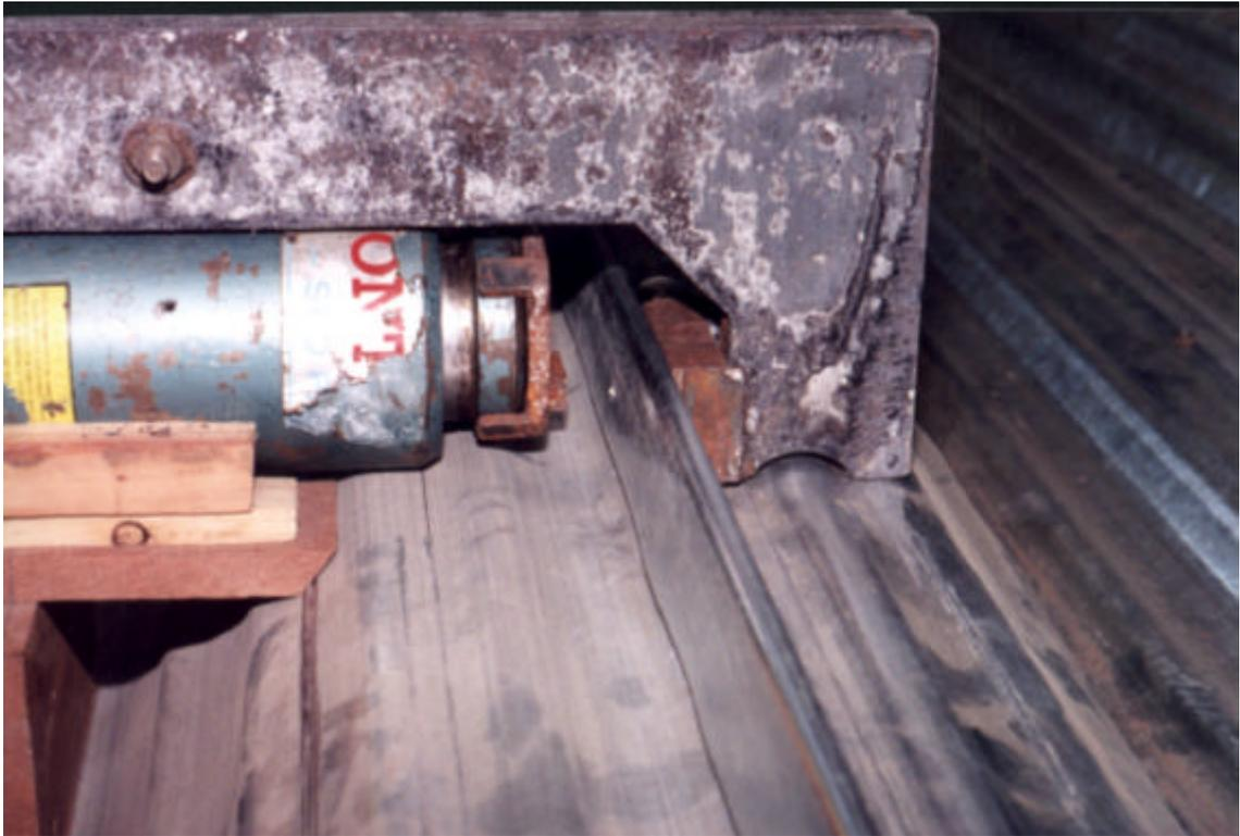
Figura 3.6 - Registra o dispositivo utilizado para executar o esmagamento da ligação capa-telha, previsto na condição de ligação das telhas designadas pelo número 3.
