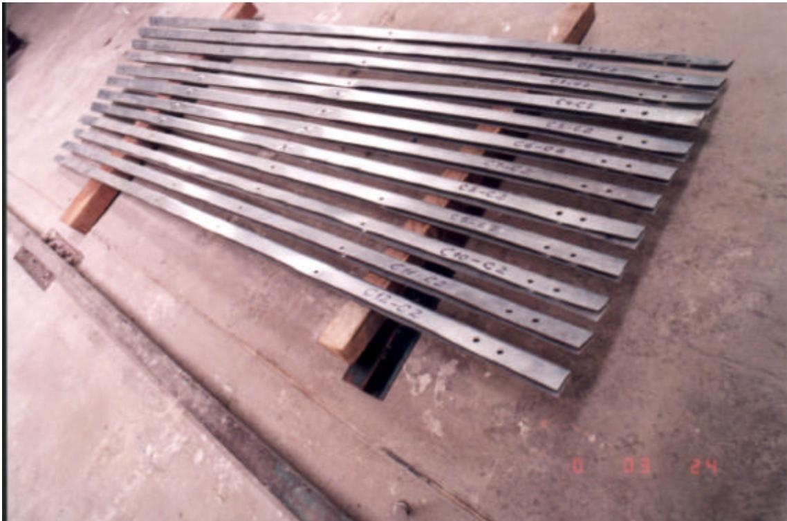
Figura 3.3 - Registra as 12 capas utilizadas no espécime 2, para as condições de ligação das telhas, designadas como 2, 3 e 4.
