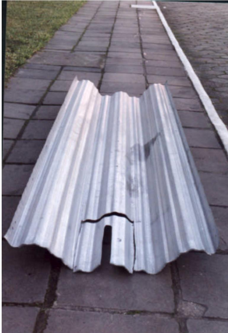
Figura 2.5 - Exibe, na telha central do espécime 3, região junto ao apoio norte, a amostra de onde foi extraído o corpo-de-prova de número 3.
