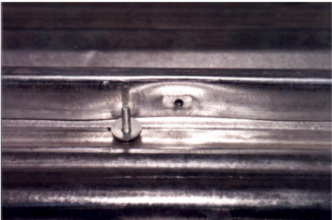
Figura 3.7 - Detalhe do esmagamento final, observado na posição do furo do parafuso, da ligação capa-telha.
