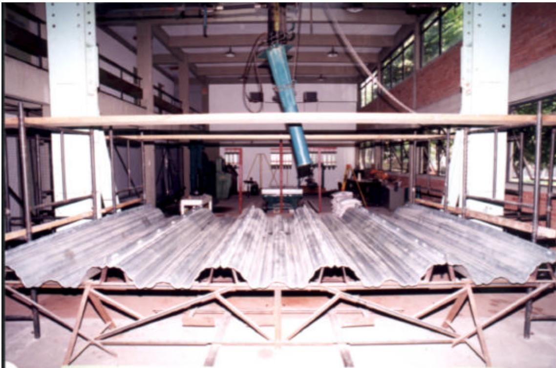
Figura 3.15 - Mostra o cavalete de apoio utilizado em ambas as extremidades do espécime de telhas.
