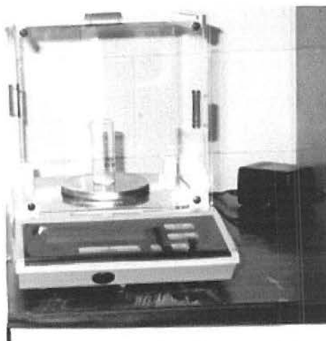
Fig. 3.3. Balança moderna com divisão de verificação igual a 0,001g, liberada pelo INMETRO até final de 2001.
