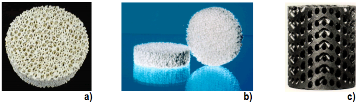
Figura 2.3: Exemplos de materiais para utilização em queimadores porosos: zircônia (a), alumina (b) e carboneto de silício (c).
