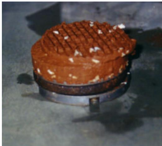
Figura 4.9 – Corpo-de-prova de solo-cimento-poliestireno expandido cisalhado
