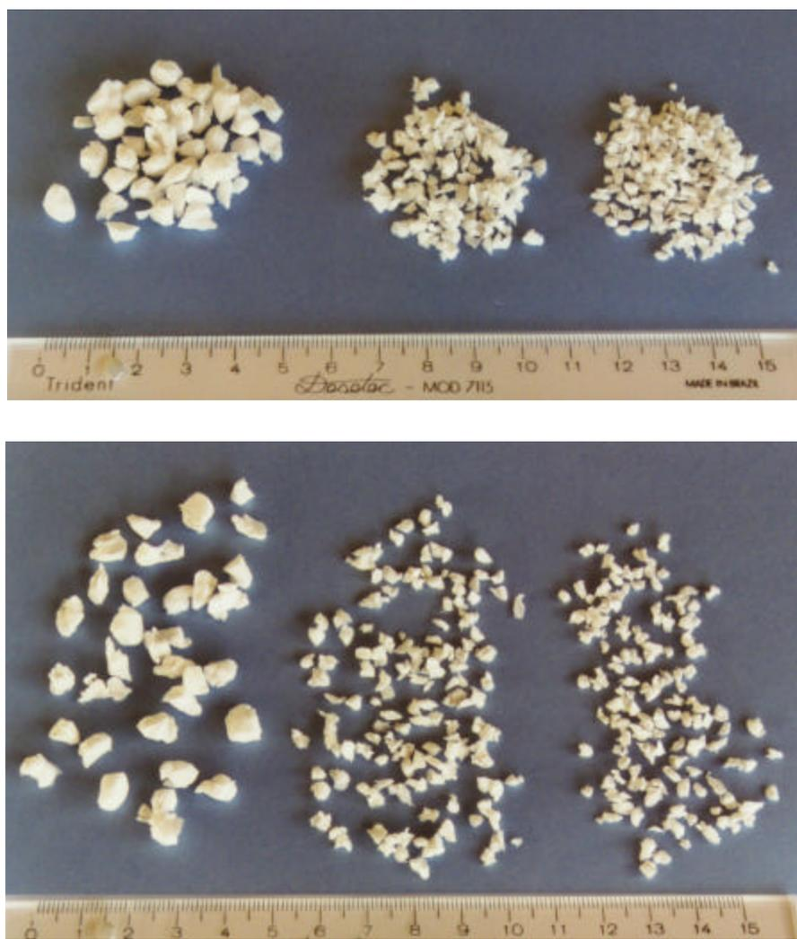
Figura 4.1 – Tamanhos utilizados de partículas de poliestireno expandido
