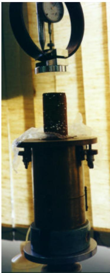
Figura 4.3 – Configuração: prensa e amostra, durante ensaio
