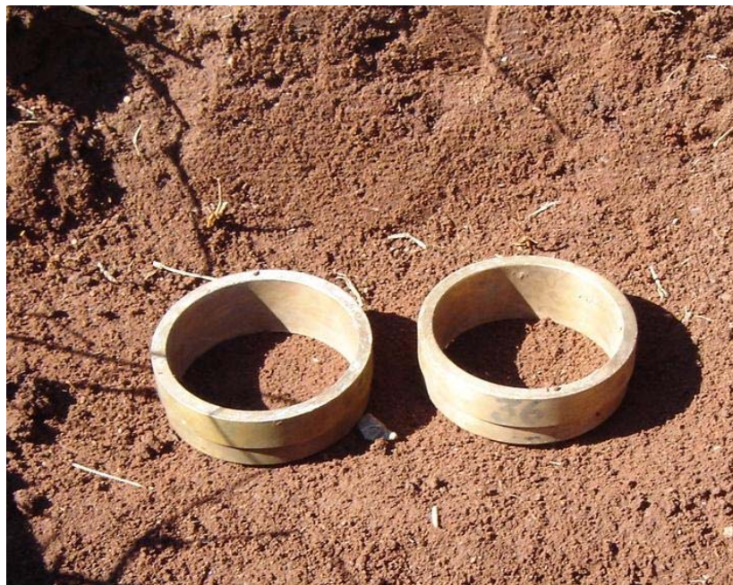
Figura 12. Anéis utilizados para a coleta de amostras de solo indeformadas destinadas à realização do ensaio de compressão uniaxial.
