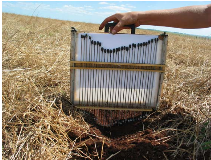
Figura 26. Perfilômetro de varetas utilizado para a determinação da profundidade máxima do sulco e área da seção transversal de solo mobilizado pelas hastes sulcadoras de adubo durante a semeadura das culturas de verão.
