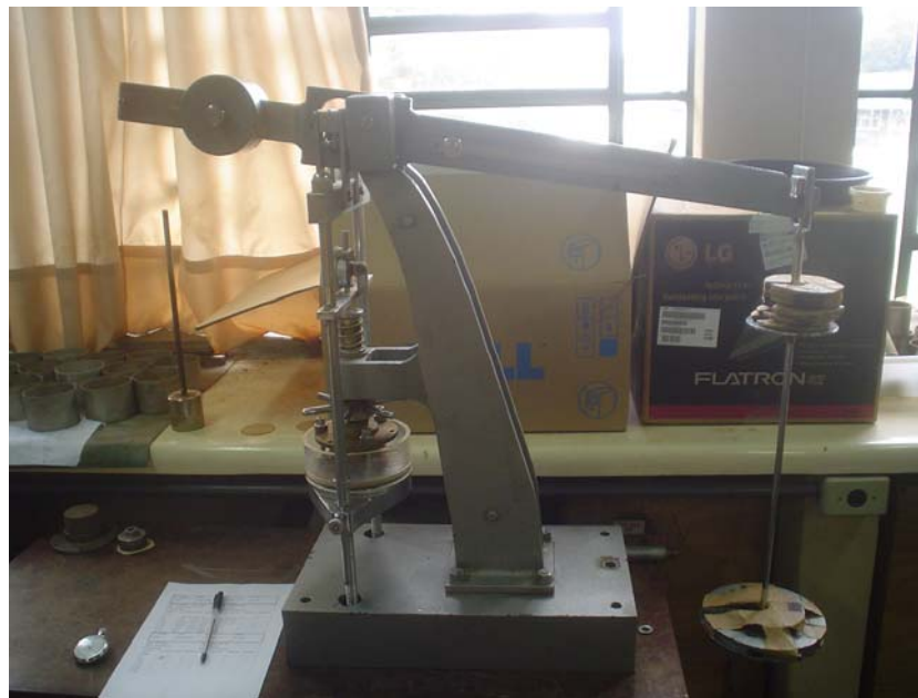
Figura 13. Prensa oedométrica utilizada no ensaio de compressão uniaxial.
