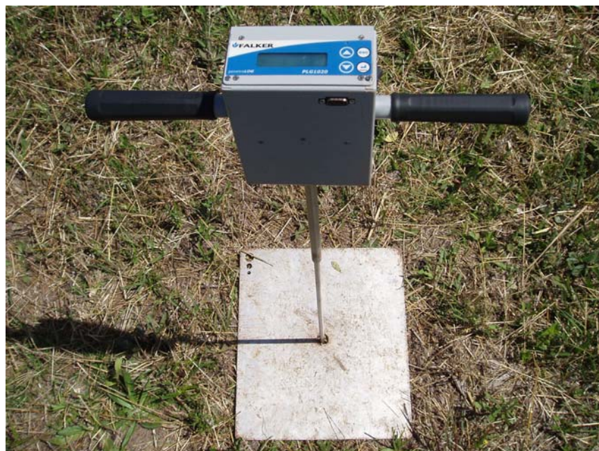
Figura 2. Penetrômetro utilizado para determinação da resistência do solo à penetração em outubro de 2005 e junho e novembro de 2006.
