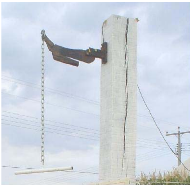
Figura 24. Posição da haste sulcadora de adubo e seu respectivo suporte durante a calibração dos extensômetros de resistência elétrica.
