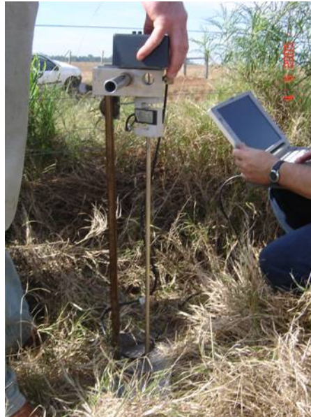
Figura 1. Penetrômetro utilizado para determinação da resistência do solo à penetração em outubro de 2005 e junho e novembro de 2006.
