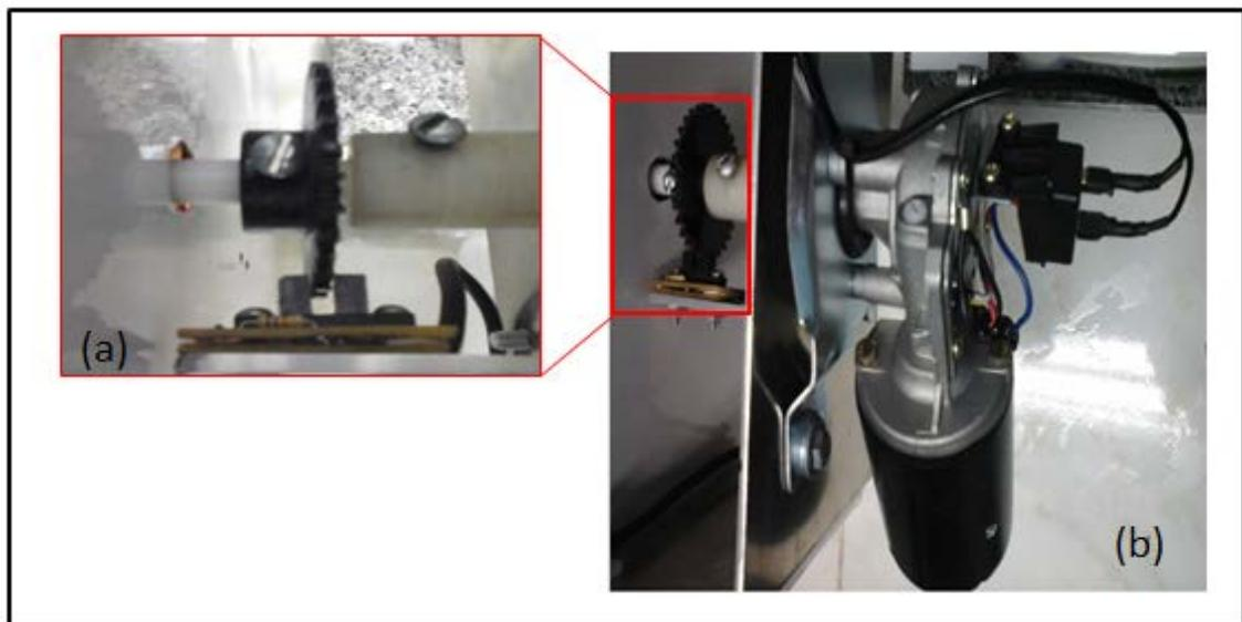
Figura 5.7: (a) Chave óptica interruptiva e (b) motorreductor.
