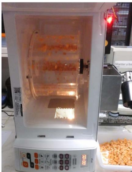
Figura 6.1: Esquema de tambor rotativo com micro-ondas com batata-doce.
