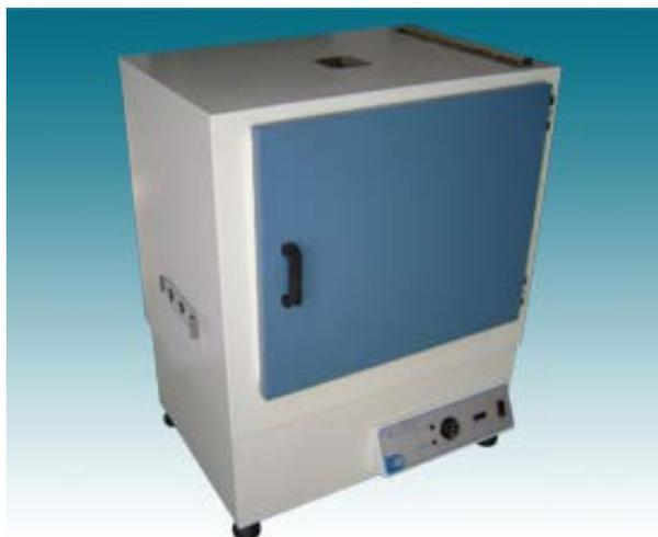
Figura 4.3: Estufa de secagem com circulação e renovação de ar.
