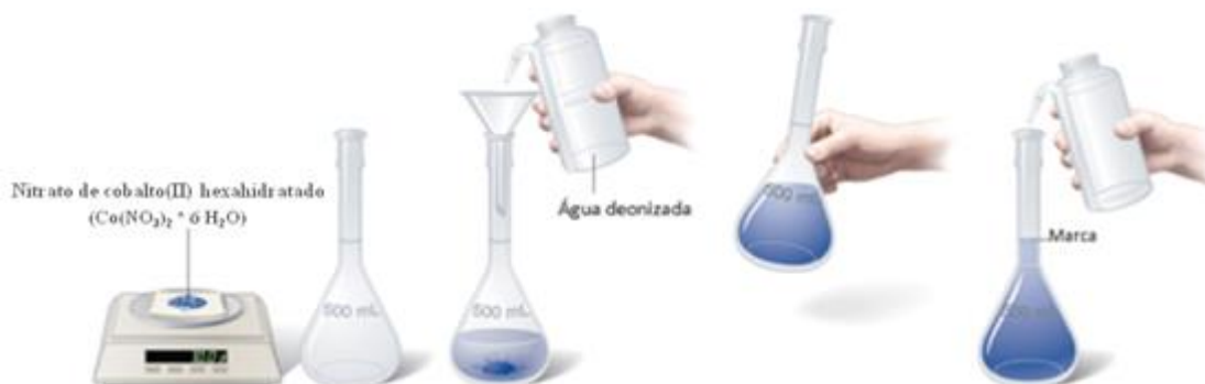
Figura 5.2 Esquema de preparação da formulação da solução precursora para Spray-pirólise .
