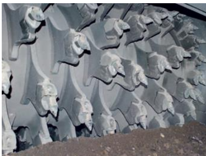
Figura 7: Cilindro e bits de corte de uma recicladora (WIRTGEN, 2007)
