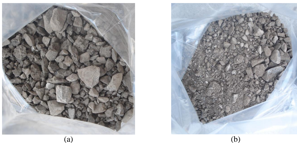
Figura 17: Amostras de (a) fresado asfáltico e (b) brita graduada
