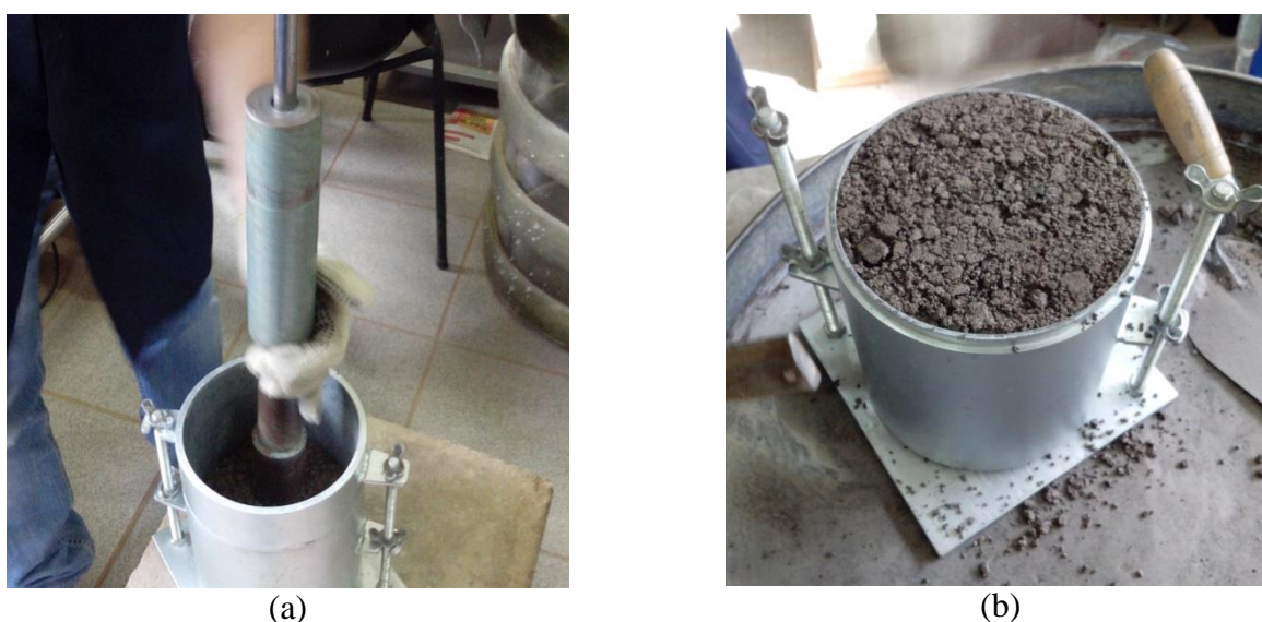
Figura 19: Procedimento para (a) compactação de uma das camadas e (b) aparência da mistura de código 6-20-INT com teor de umidade igual a 8% após compactação
