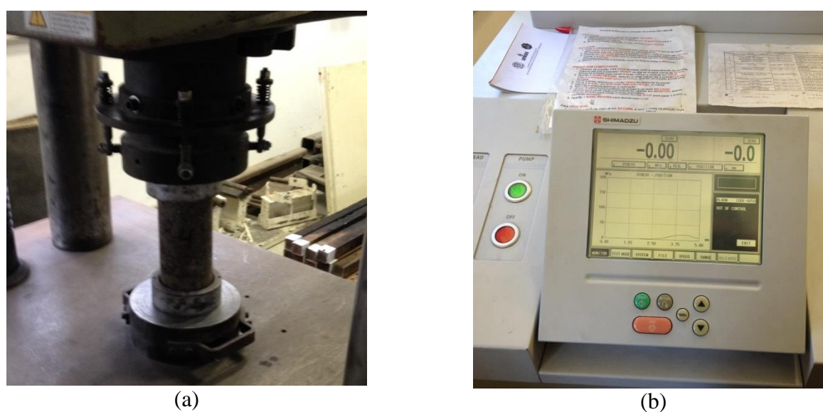
Figura 21: Realização da (a) ruptura do corpo de prova à compressão e demonstração do (b) sistema digital para programação do ensaio
