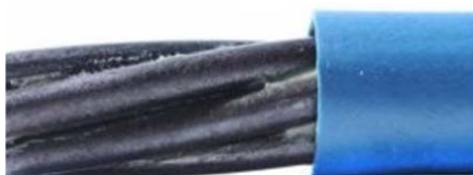
Figura 88: Cordoalha engraxada em bainha de PEAD
