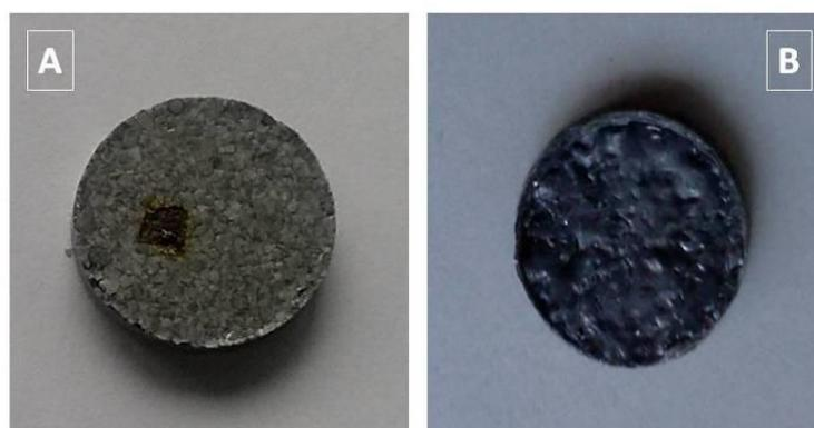
Figura 17. a) Pólvora CHOG pastilhada. Imagem obtida após medição, mostrando a marca deixada pelo feixe de prótons de 2 MeV. b) Pólvora EXPO +P+ pastilhada.
