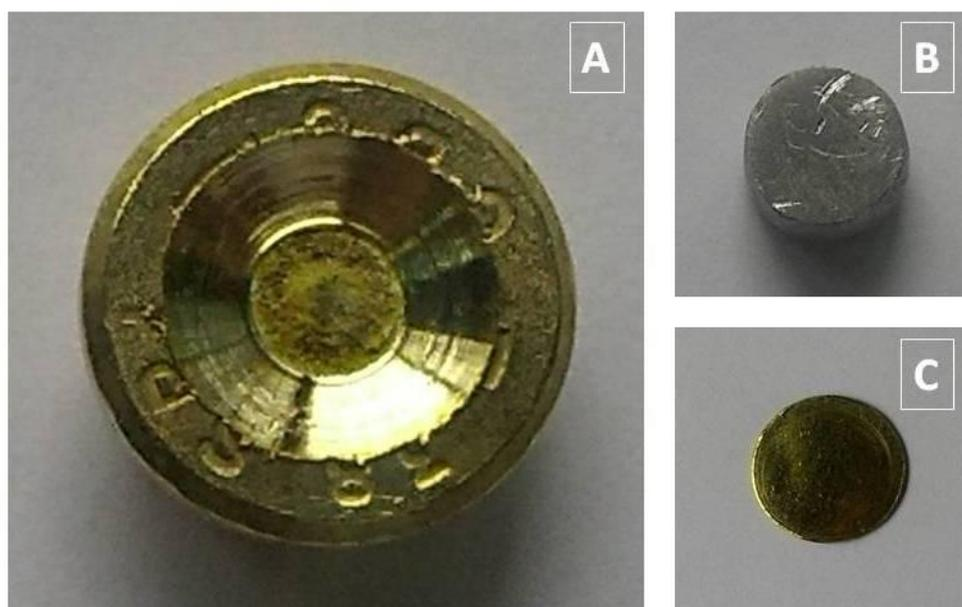
Figura 18. Amostras prontas para análise por PIXE. a) espoleta, b) projétil e c) estojo.
