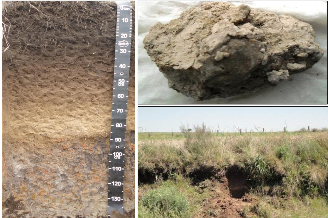
Figura 15: Perfil de solo, rocha alterada coletada in situ , e vista geral da localização do perfil 17 RS.
