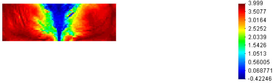
Figura 11.64: Verificação do critério de fadiga F1
