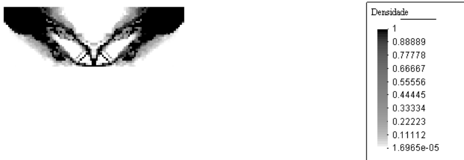
Figura11.51: Exemplo “h”): otimização topológica com restrição de tensão
