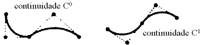
Figura 6.3: Curva de Bézier: (a) continuidade C^0 ; (b) continuidade C^1
