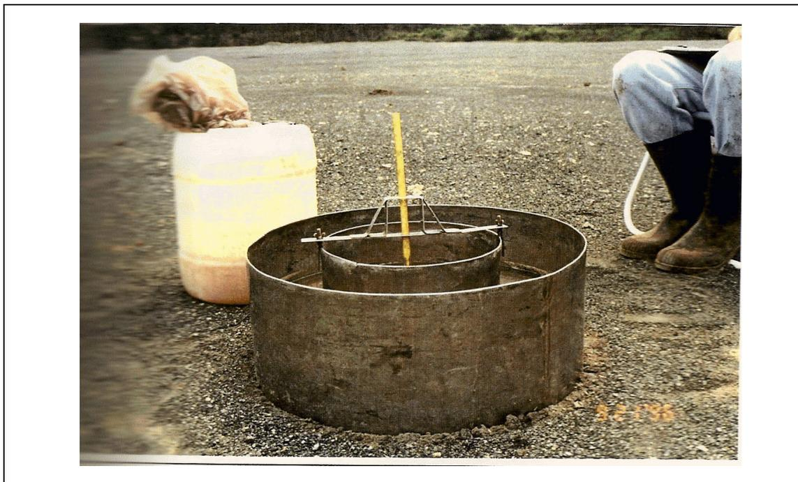
Figura 26: Teste de infiltração realizado através do método dos cilindros concêntricos.
