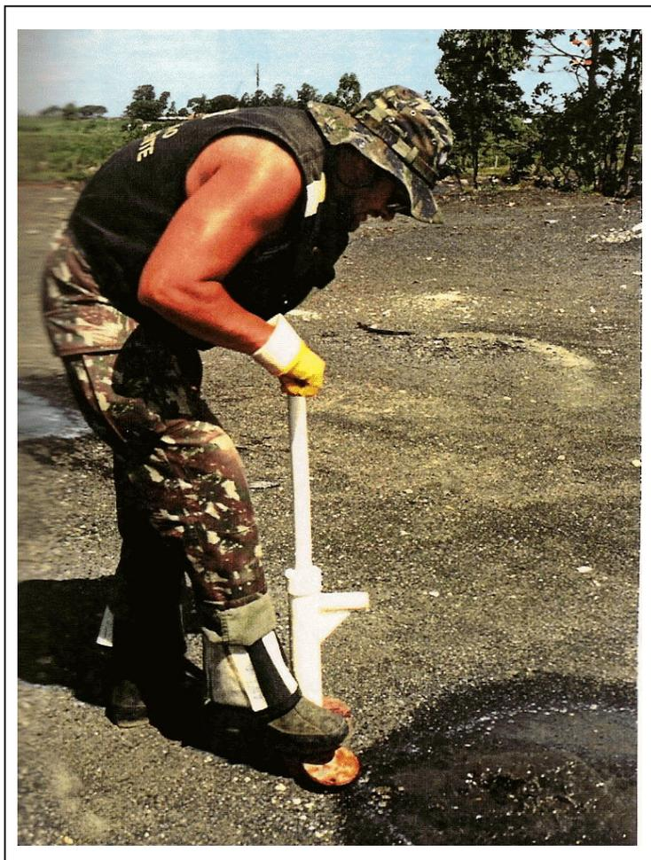
Figura 28: Bomba manual do tipo pistão de PVC com a qual é realizado o esgotamento dos piezômetros.
