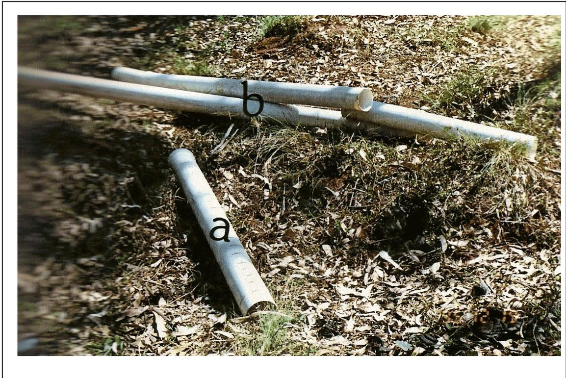
Figura 23: Canos de PVC utilizados para a montagem dos piezômetros onde observa-se em (a) os canos ranhurados colocados na porção final do piezômetro e em (b) os canos inteiros.
