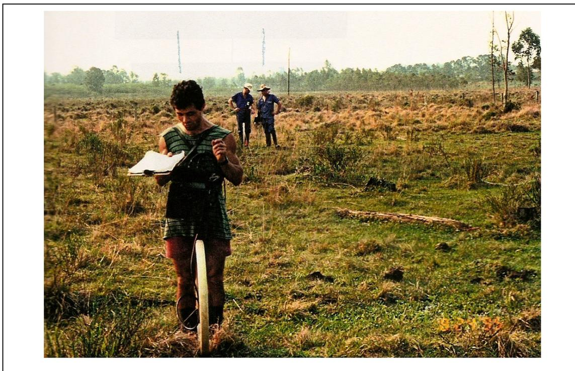
Figura 18: Detalhe da aplicação do método eletromagnético EM-34-3.
