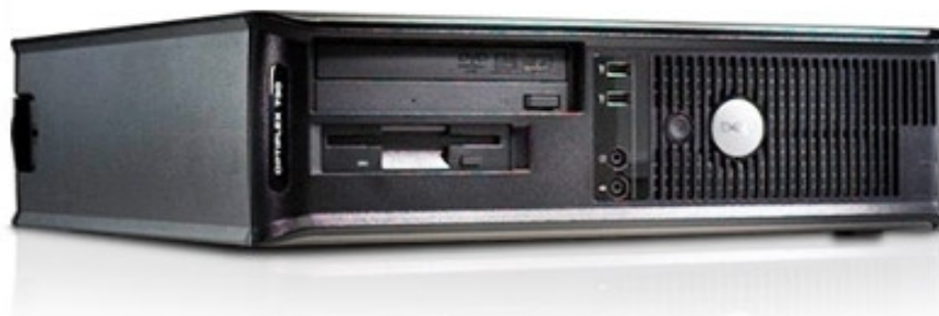
Figura 10 - Gabinete no padrão BTX, no formato SFF da DELL. Dimensões: A: 31,63cm x L: 9,26cm x P: 34 cm
