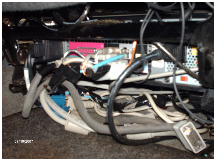
Figura 34 - Saída de cabos da CPU com as conexões: headset ; 6 portas USB traseiras; entrada de alimentação; placa de rede com fio; placa de rede sem fio; porta serial, 2 saídas de vídeo; e uma porta paralela ainda sem utilização.
