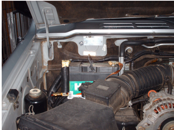
Figura 28 - Localização da segunda bateria junto ao compartimento do motor.
