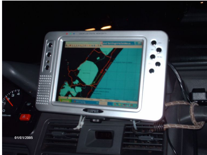
Figura 17 - Navegação noturna – teste preliminar entre Porto Alegre e Florianópolis. O monitor mostra a posição do veículo, entre a Lagoa do Quadros e Lagoa Itapeva – RS.
