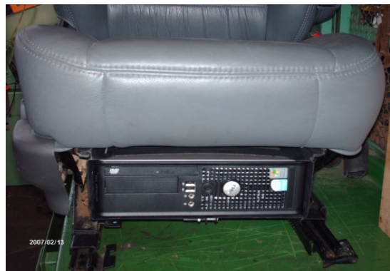
Figura 15 - CPU já com a gaveta encaixada e fixada no banco.
