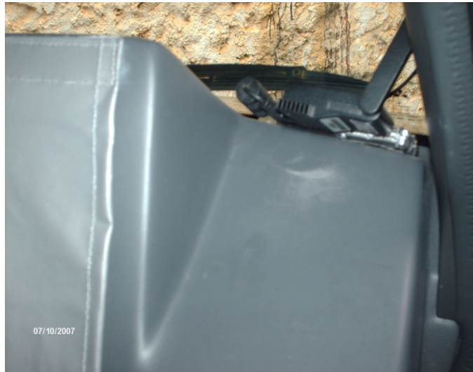
Figura 36 - Localização de célula expansora junto ao painel no lado do navegador.
