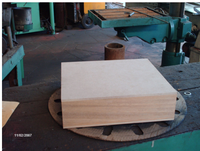
Figura 12 - Molde de madeira com as mesmas dimensões da CPU.
