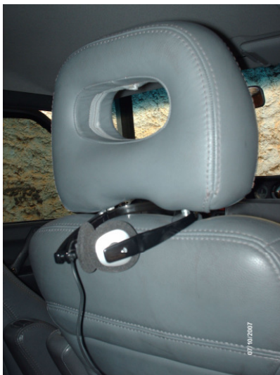
Figura 33 - Headset instalados junto ao banco do navegador.
