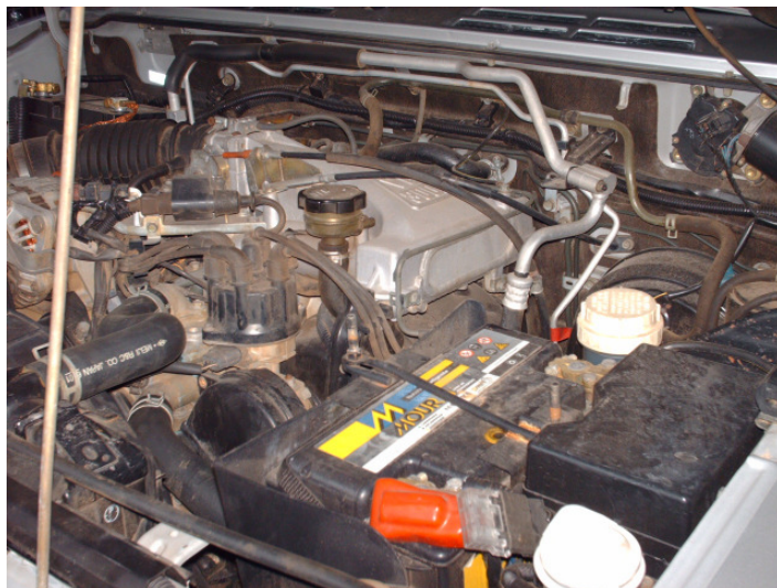
Figura 29- Ambas as baterias instaladas, a principal e original é a da direita em destaque, a segunda está no canto superior esquerdo.
