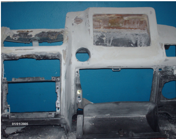
Figura 24 - O painel remodelado com fibra de vidro pronto para etapa de acabamento.
