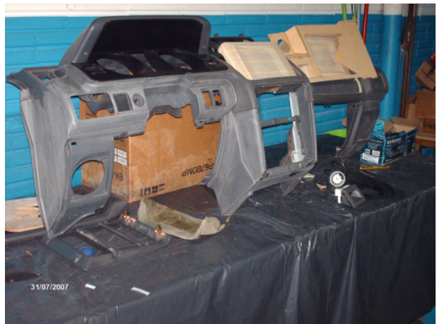
Figura 23 - O painel com os monitores e o molde de papel para o segundo monitor.
