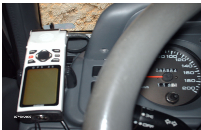
Figura 41 - O GPS adaptado ao veículo em um suporte conectado e instalado no painel próximo ao motorista, sendo facilmente removível no caso de necessidade de uso externo.
