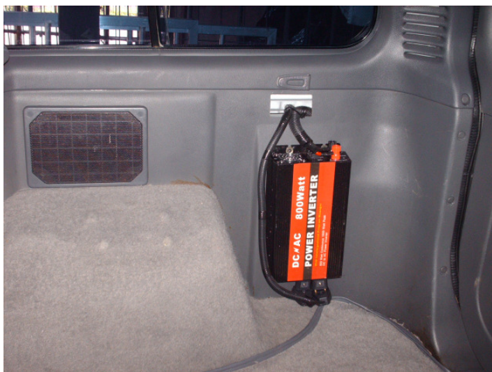
Figura 26 - Foto do inversor e os cabos de distribuição de energia para o sistema.
